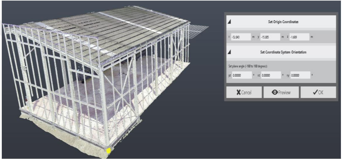
Şekil 3.31. Mevcut Örnek Çelik Yapının ReCap Modeli – Köşe Koordinatlarının Tespiti (Autodesk, ReCap 2026).
