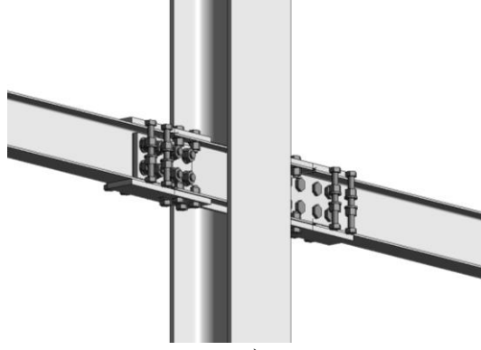
Şekil 3.32. Mevcut Örnek Çelik Yapının Revit Modeli – Kesit Görünümleri (Autodesk, Revit 2026).
