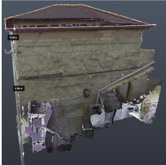
Şekil 4.12. Mevcut Örnek Yığma Yapının Beden Duvarlarının Düşeydeki Aks Kontrolü (Autodesk, ReCap 2026).
