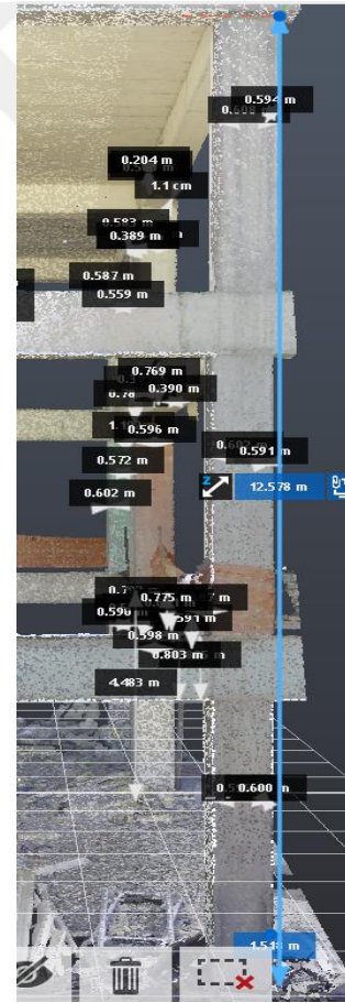
Şekil 4.4. Mevcut Örnek Betonarme Yapının Kolonunun Düşeydeki Aks Kontrolü (Autodesk, ReCap 2026).
