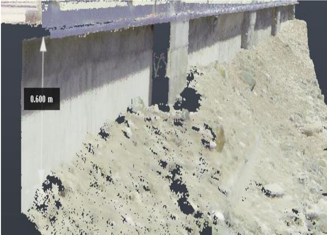
Şekil 3.30. Mevcut Örnek Çelik Yapının ReCap Modeli – Temel Detaylarının Tespiti (Autodesk, ReCap 2026).
