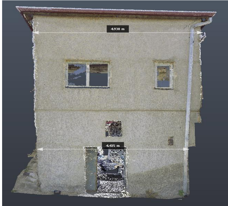
Şekil 4.13. Mevcut Örnek Yığma Yapının Beden Duvarlarının Yatay Düzlemdeki Aks Kontrolü (Autodesk, ReCap 2026).
