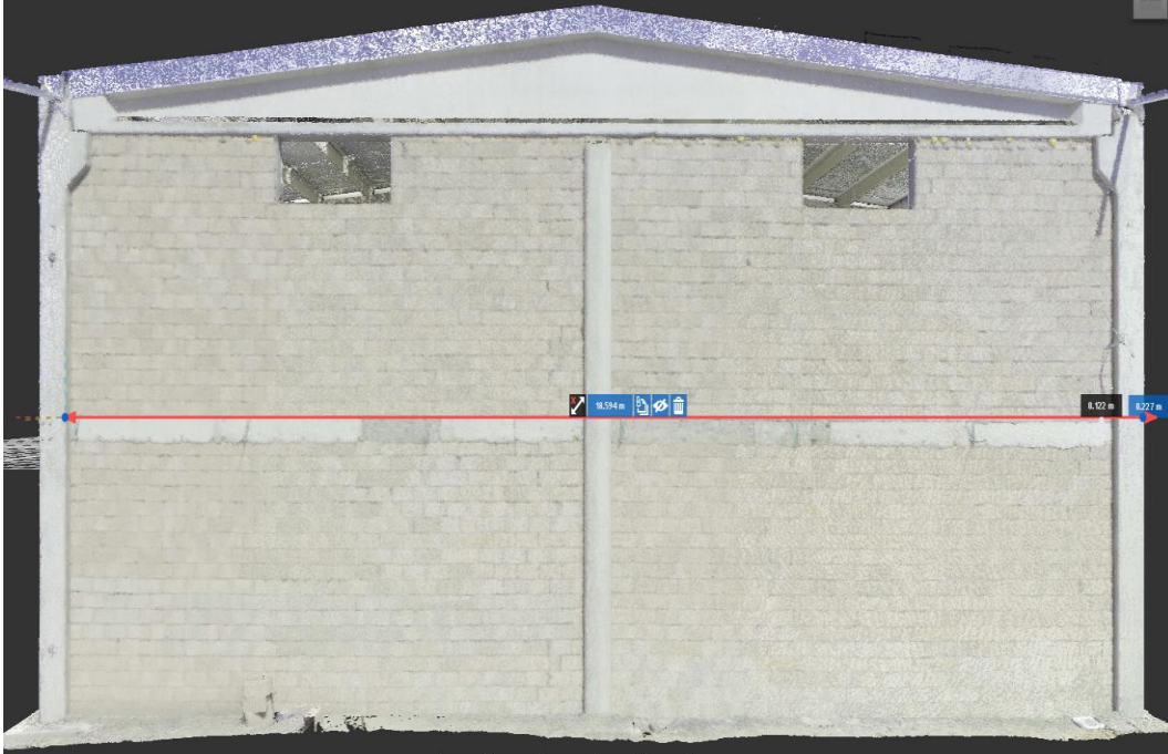
Şekil 4.11. Mevcut Örnek Prefabrik Yapının Kirişinin Yataydaki Aks Kontrolü (Autodesk, Revit 2026).
