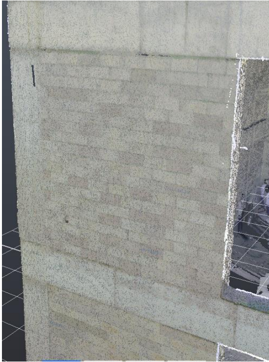
Şekil 3.19. Mevcut Örnek Betonarme Yapının ReCap Modeli - Duvar Detaylarının Tespiti (Autodesk, ReCap 2026).
