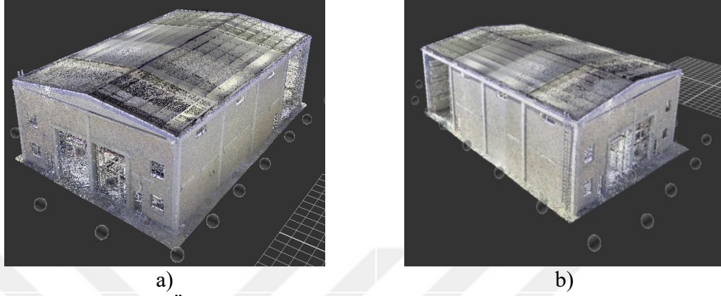
Şekil 3.11. Mevcut Örnek Prefabrik Yapıya Ait 3D Lazer Tarama Uygulamaları (Autodesk, ReCap 2026).
