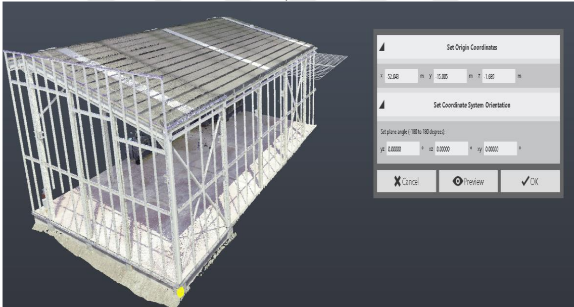
Şekil 4.5. Mevcut Örnek Çelik Yapının Köşe Koordinatlarının Tespiti (Autodesk, ReCap 2026).
