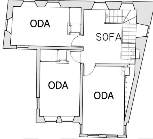
Şekil 4.74 Mahmut Dede Sk. No:20'de bulunan yapının restitüsyon projesine ait zemin kat planı (Argun Kocadağistan, 2022)
