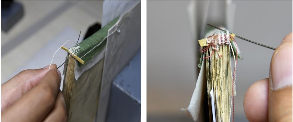
Şekil 3. 55. Kolon dikişi ve şiraze tamamlama
