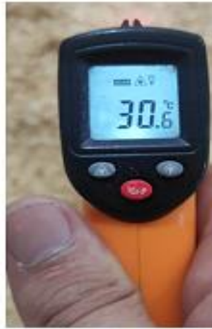
Zemin sıcaklığı ölçümü
