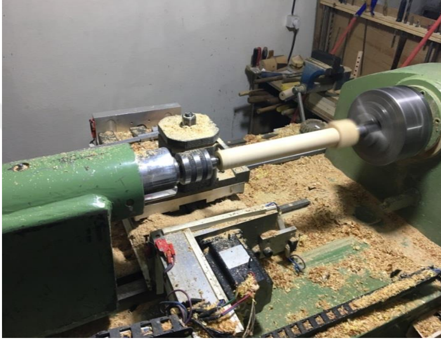
Resim 8: Mey çalgı gövdesinin kabasının alınması
