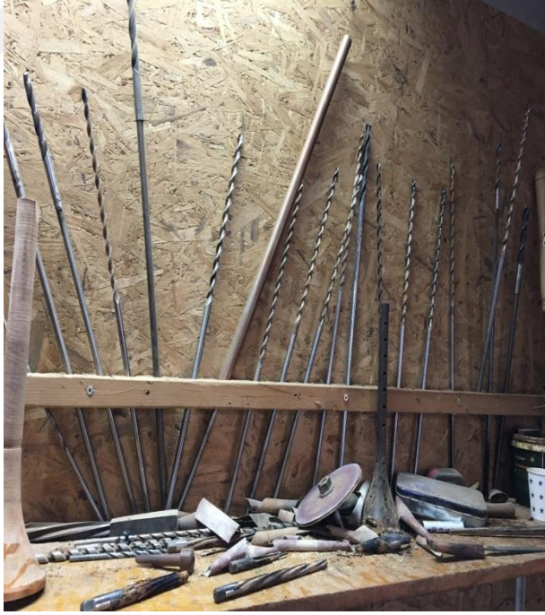
Resim 19: Mey çalgı gövdesinin yapımında kullanılan bıçaklar
