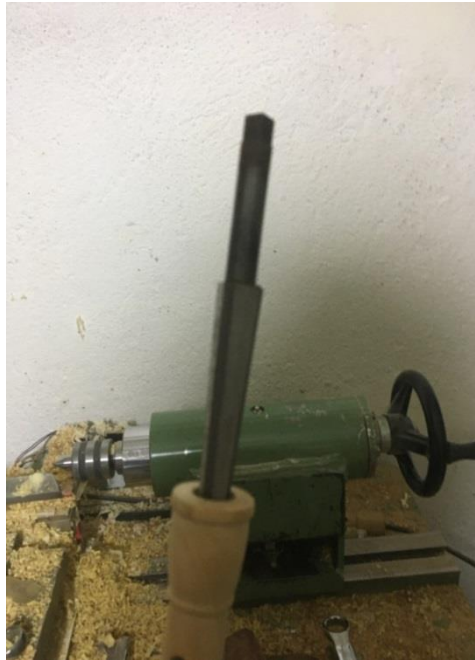
Resim 42: Mey gvdesinin boğaz kısmının açılması
