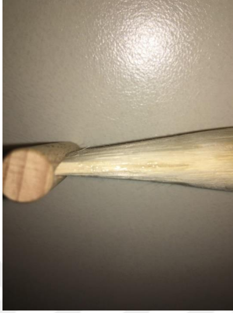
Resim 54: Kamışın yanlarının “Pattex Gel” yapıştırıcı ile yapıştırılması
