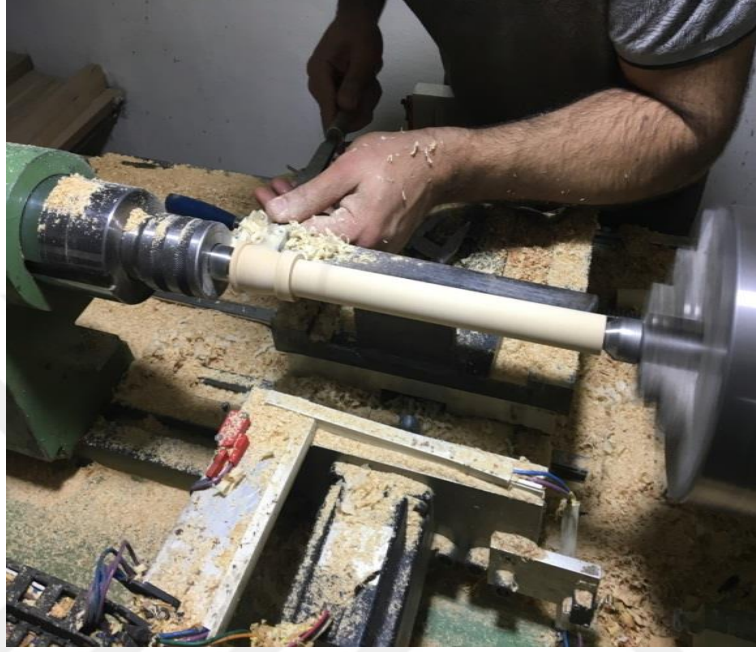
Resim 41: Mey gvdesinin baş kısmının şekillendirilmesi
