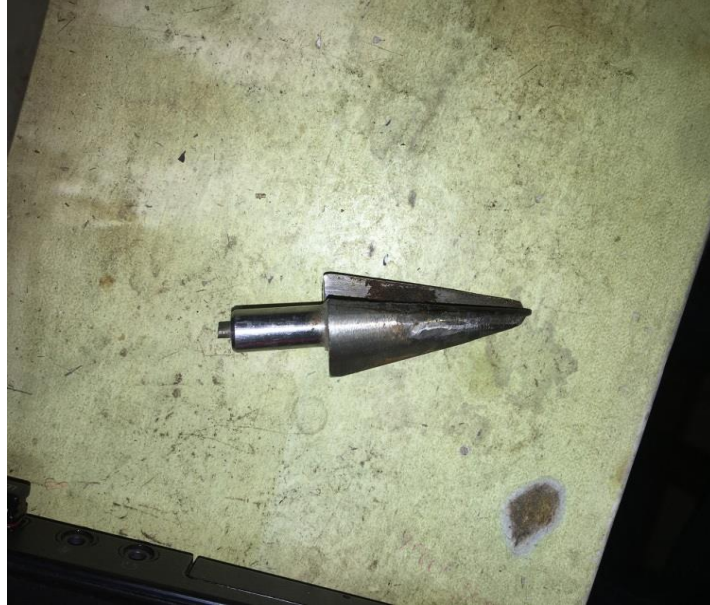
Resim 24: Mey algısında ağız ıkısı iin kullanılan konik bıak
