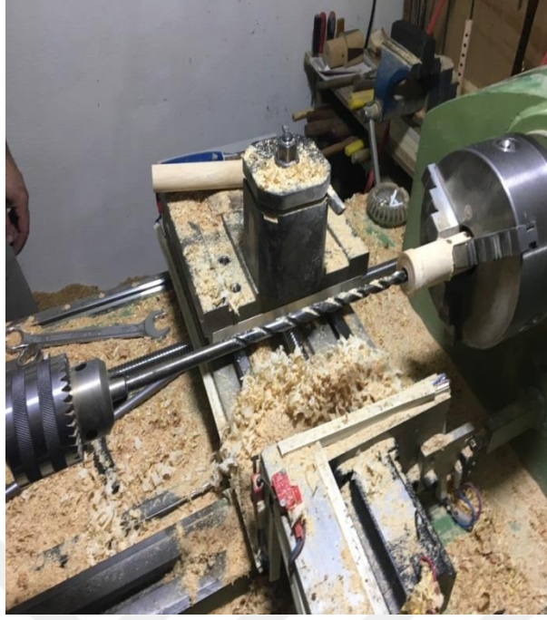
Resim 5: Mey algı gvdesinin i kısmının delinmesi
