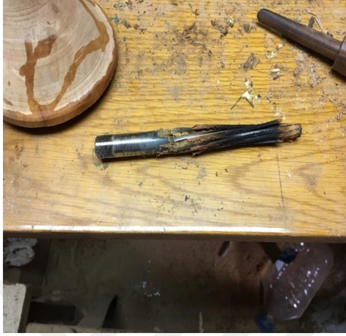
Resim 20: Mey ağız açkısı için kullanılan konik bıçak
