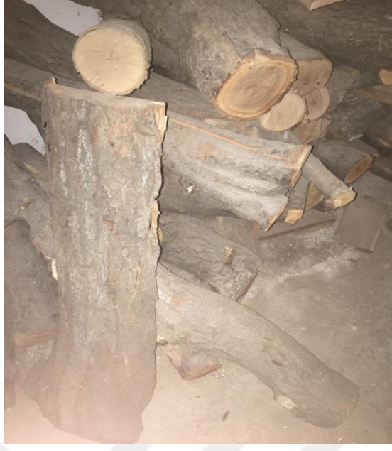
Resim 33: Kesilen Ağaçların istiflenmesi ve bekletilmesi
