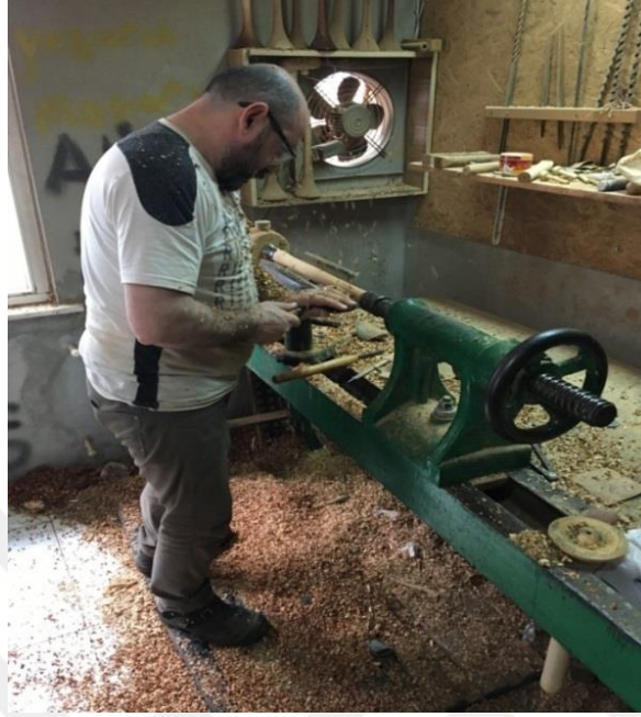
Resim 17: Mey çalgı gövdesinin kabasının alınması
