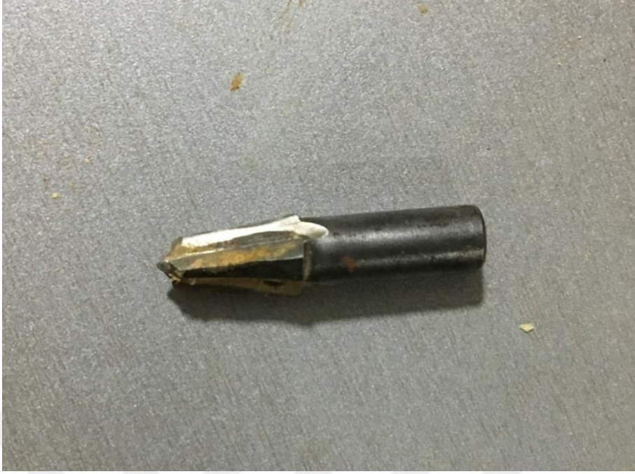
Resim 11: Mey ağız açkısı için kullanılan konik bıçak
