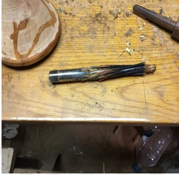
Resim 23: Mey algısında ağız ıkısı iin kullanılan konik bıak
