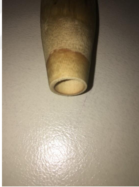
Resim 53: Kamışın alt boğumunun zımparalanarak oval şekle getirilmesi
