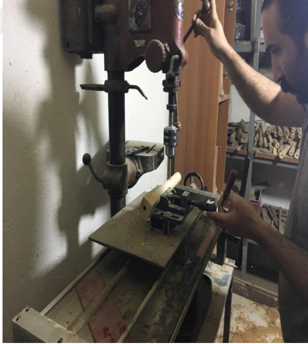
Resim 6: Mey algı gvdesinin perdelerinin delinmesi
