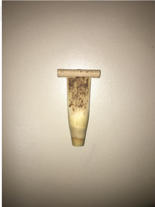
Resim 55: Kamışın zımpara ile pürüzleri alındıktan sonra ağız kısıkcı kapalı bir şekilde demir ile dađlatılması
