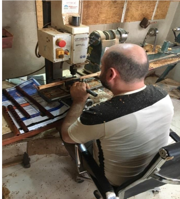
Resim 18: Mey çalgı gövdesinin perdelerinin delinmesi
