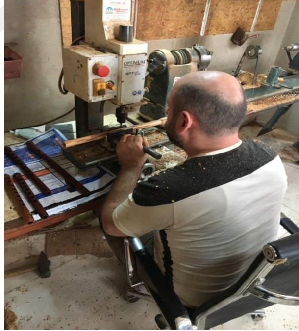
Resim 15: Mey algı gvdesinin perdelerinin delinmesi
