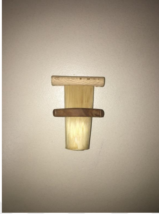
Resim 50: Kamışın kışkaçlar yardımıyla kalıba alınması
