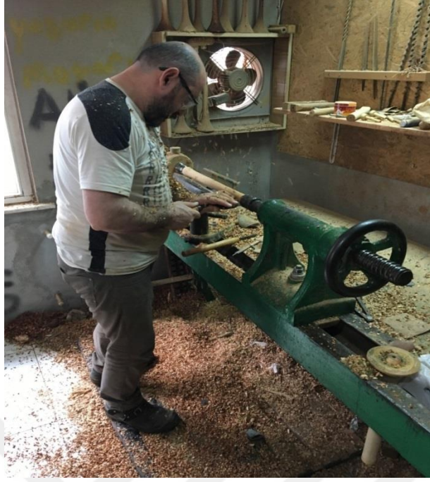
Resim 14: Mey algı gvdesinin kabasının alınması
