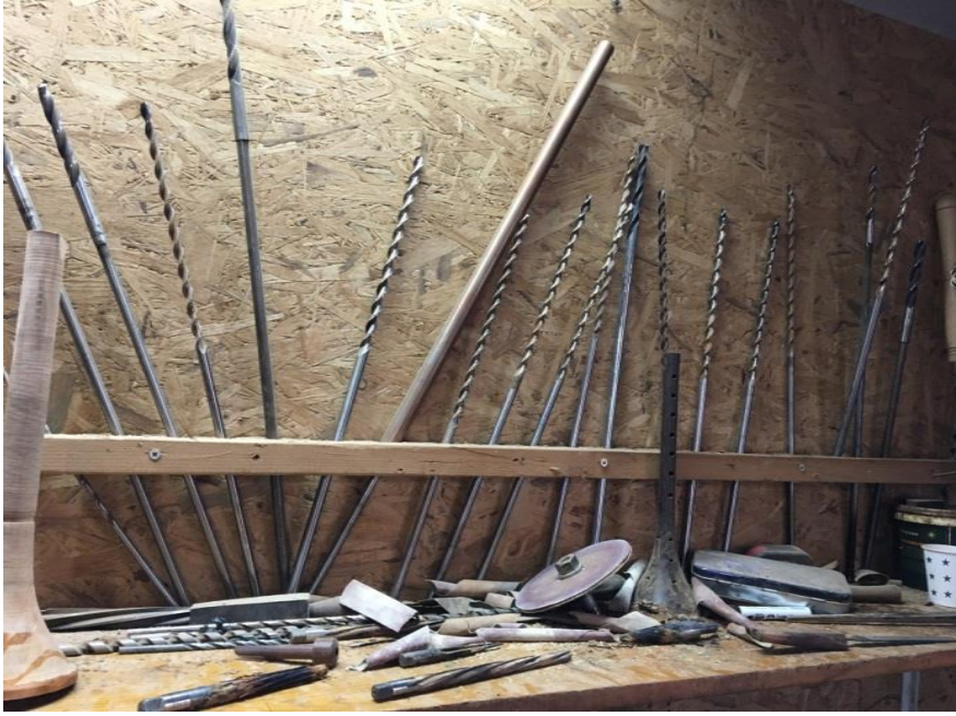
Resim 22: Mey çalgı gövdesinin yapımında kullanılan bıçaklar
