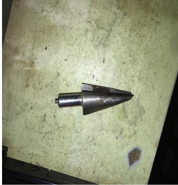
Resim 13: Mey ağız açkısı için kullanılan konik bıçak
