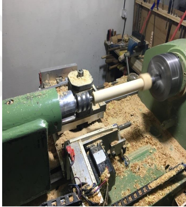
Resim 4: Mey algı gvdesinin kabasının alınması
