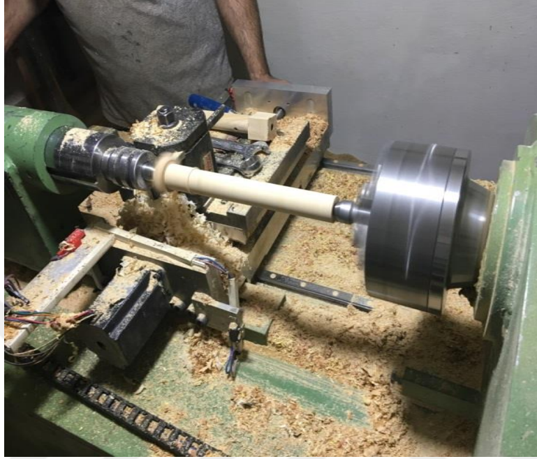
Resim 39: Mey gövdesinin baş kısmının kabasının alınması
