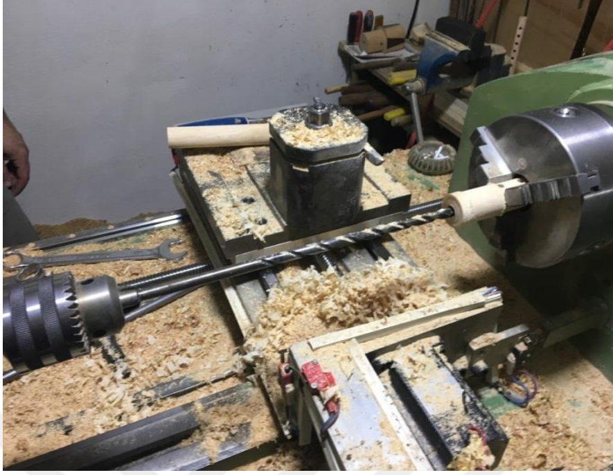
Resim 9: Mey algı gvdesinin i kısmının delinmesi
