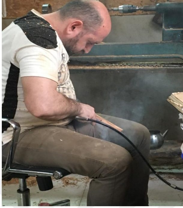
Resim 19: Mey algı gvdesinin perdelerinin akortlanması
