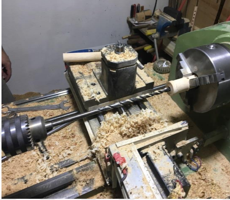
Resim 37: Mey gövdesinin içinin delinmesi
