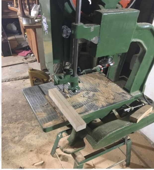
Resim 35: AĖaların 4'e 4 apında Őeritli testere ile kesilmesi
