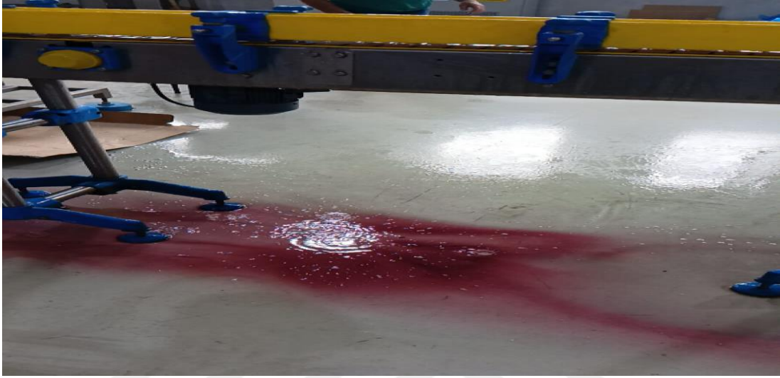
Şekil 3. Meyve suyu fabrikasına ait ıslak ve kaygan zemin görüntüsü
