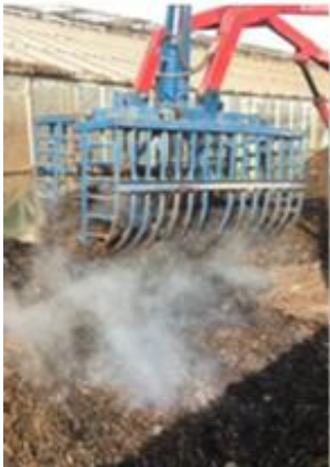
Şekil 3.8. Kompost karışım ve havalandırma
