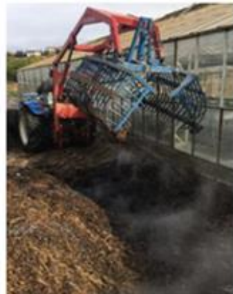
Şekil 3.8. Kompost karışım ve havalandırma
