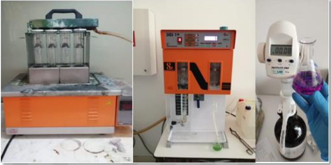
Şekil 3.13. Toprak örneklerinde N analizi (Kjeldahl yöntemi)
