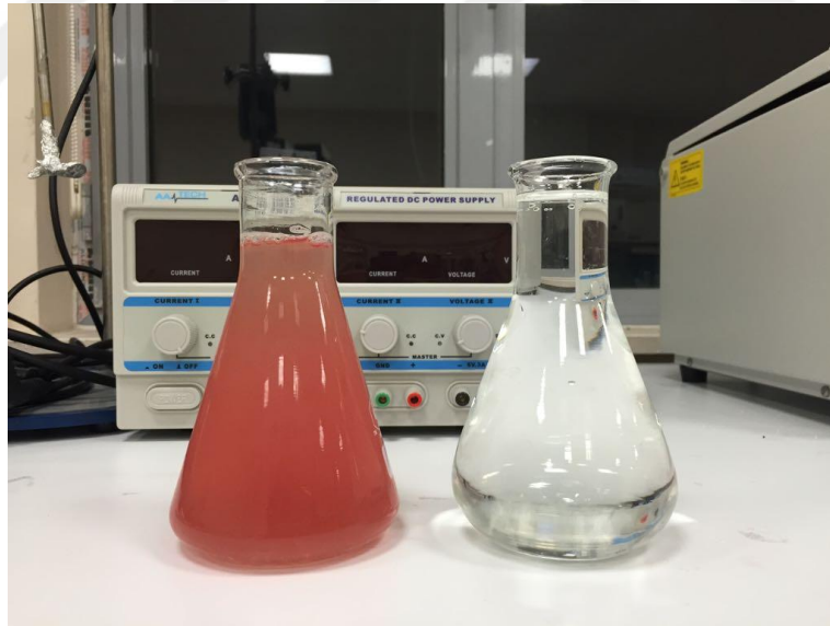
Şekil 4.1. Ham mezbaha atıksuyu ve arıtılmış atıksu.
