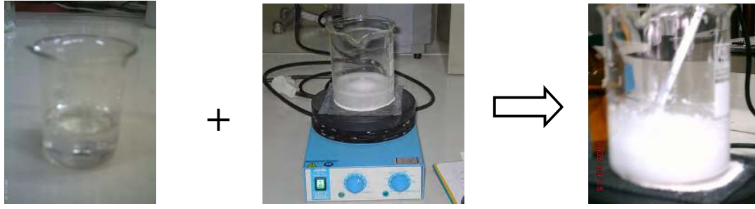
Resim 3.8. (a) sodyum silikat çözeltisinin, (b) berrak çözeltiye damla damla eklenmesiyle elde edilen (c) jel
