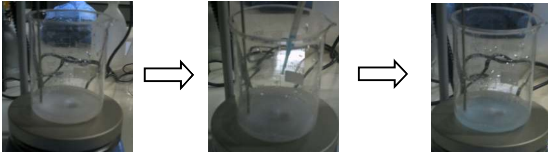
Resim 3.13. Süspansiyona bakır çözeltisinin ilave edilmesi ile elde edilen çözelti
