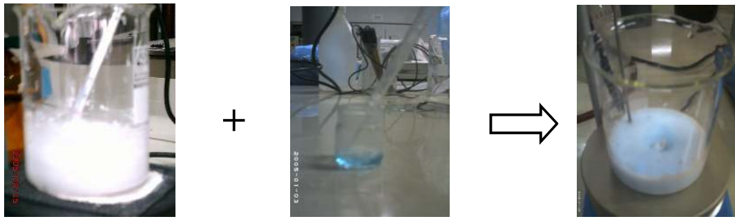
Resim 3.9. Oluşan jele damla damla eklenen bakır kaynağı
