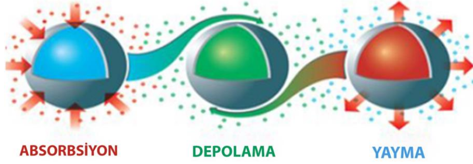
Şekil 2.6. Kapsüllemiş FDM'lerin çalışma prensibi [22]
