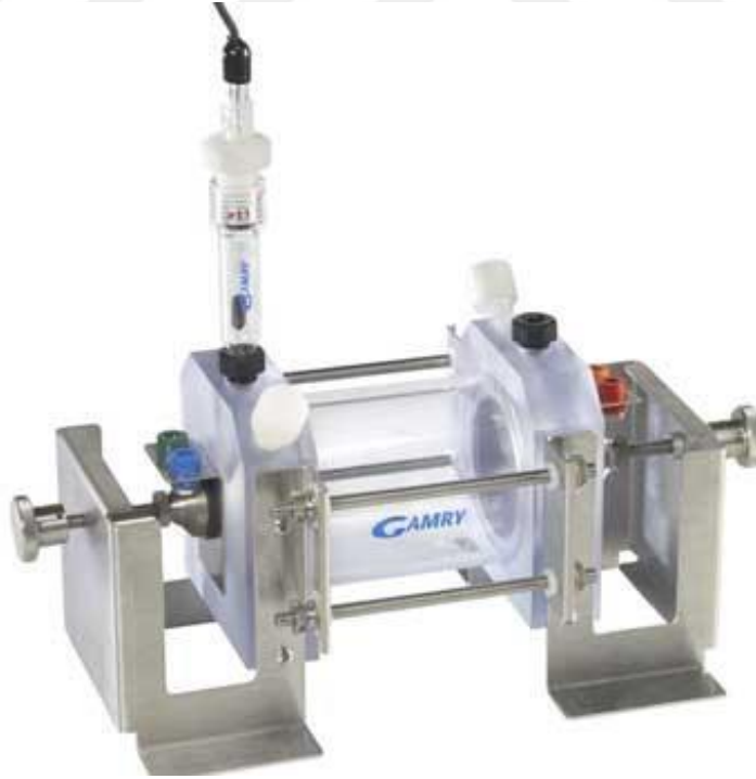
Şekil 3.5. Deneysel çalışmalarda kullanılan korozyon hücresi.
