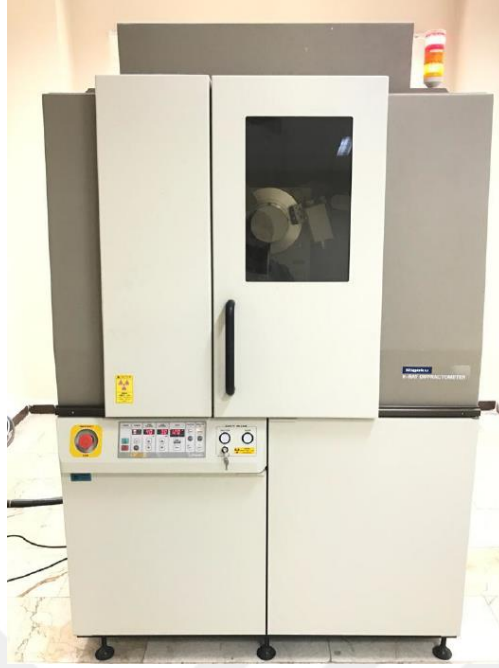
Şekil 3.2. Rigaku D/Max 2200 XRD cihazı.
