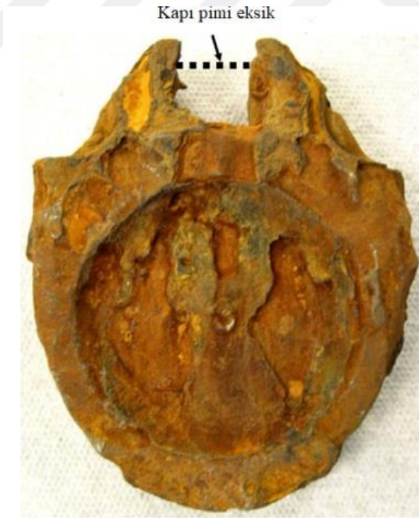
Şekil 2.20. Genel korozyon gösterimi [133].
