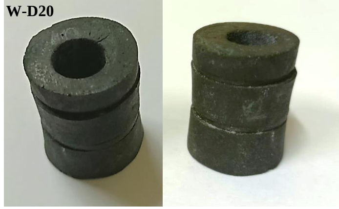
Şekil 2.9. Isıl işlem sonrası eklenmiş ve 8 mm oyuk açılmış W-D20 örneği
