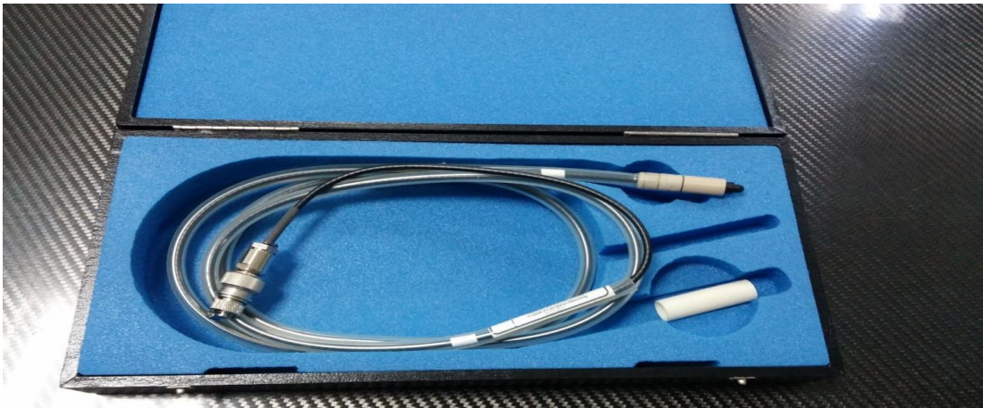
Resim 3.8. İba marka CC04 iyon odası
