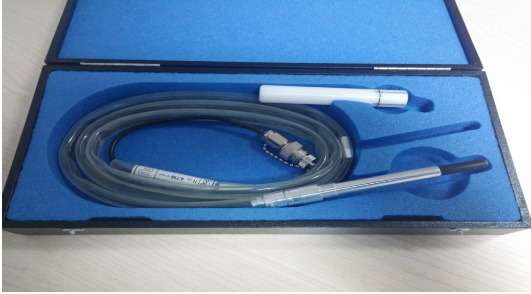
Resim 3.7. İba marka 0.65 cc farmer tipi iyon odası
