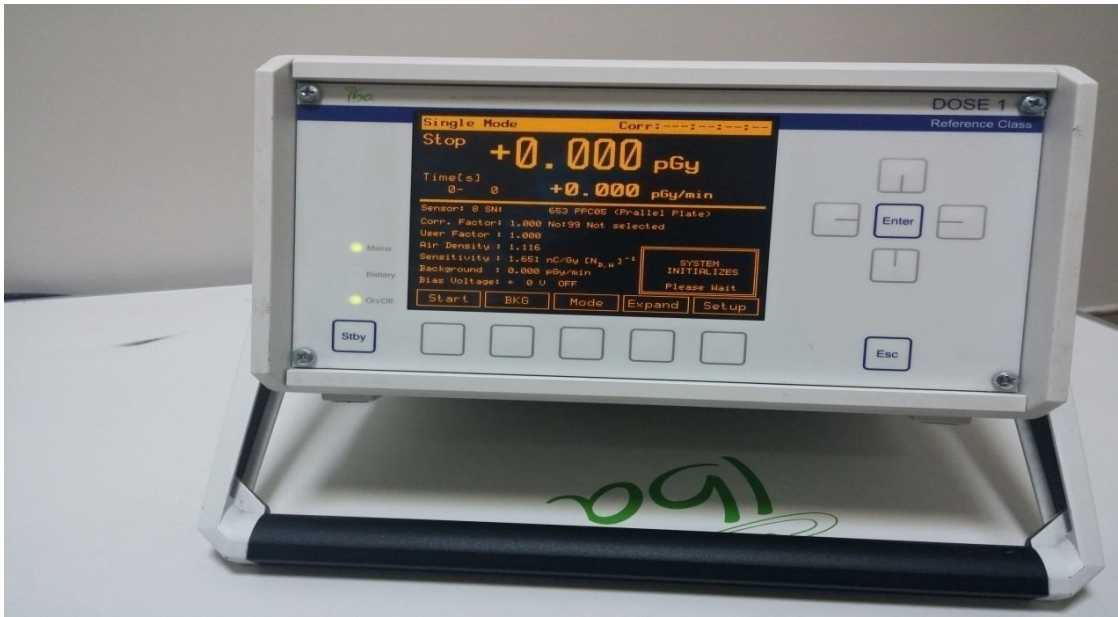
Resim 3.5. İba marka Dose 1 elektrometre
