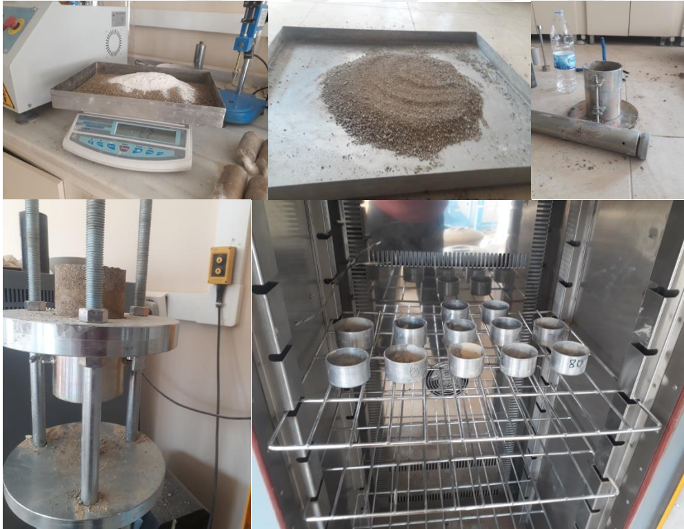
Şekil 10. Standart proktor deneyi yapım aşamaları.
