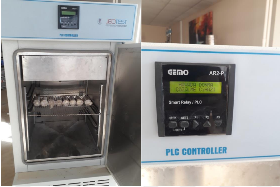
Şekil 26. Numunelerin donma-çözülme çevrimi deneyi.
