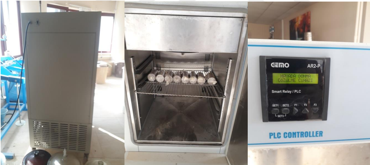
Şekil 13. Donma-çözülme deney düzeneği.
