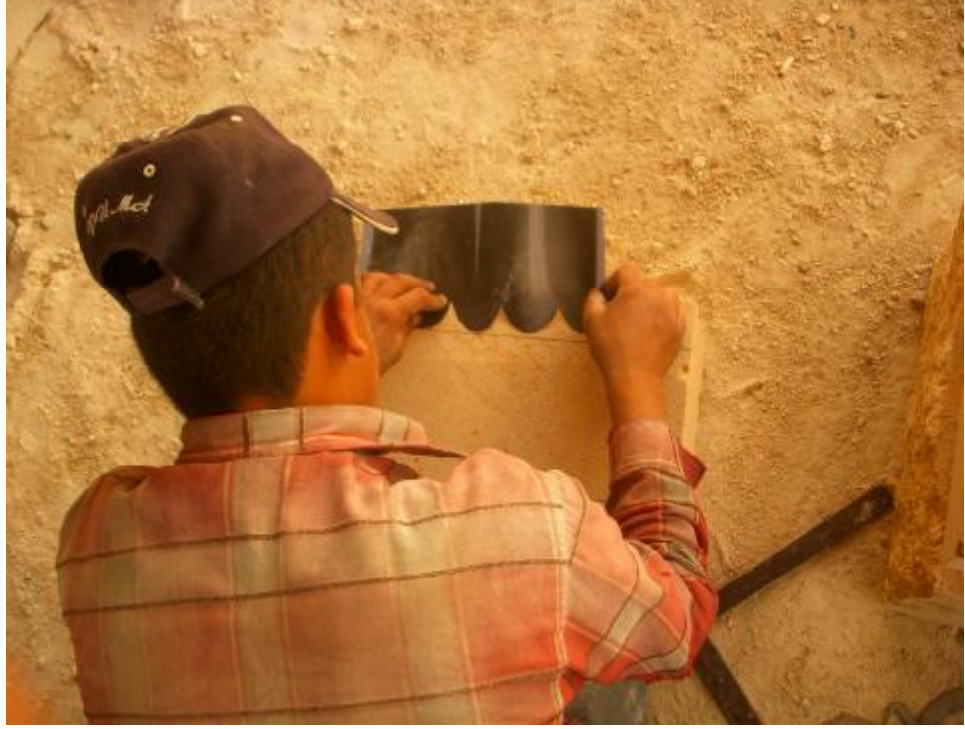
Şekil 3.9. Küçük blokların hazır şablonlarla işaretlenmesi
