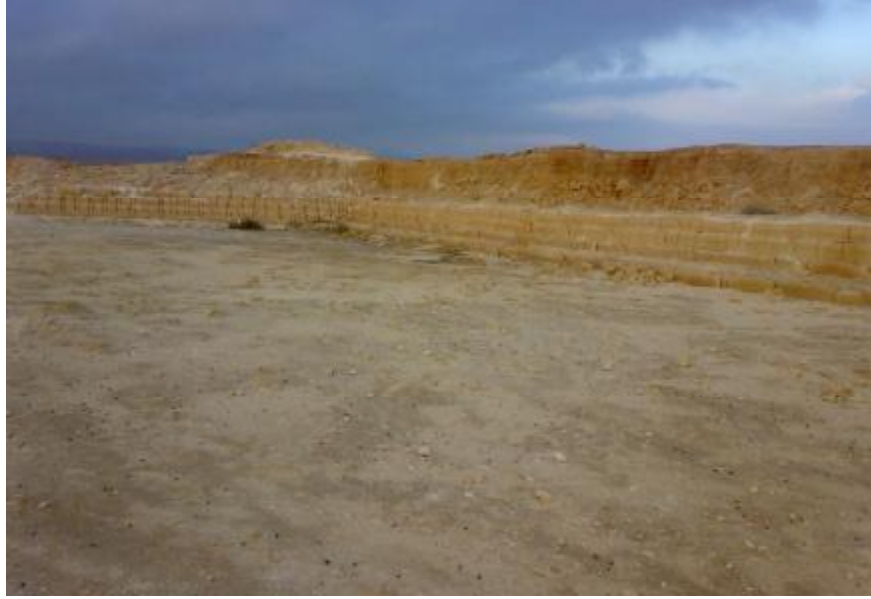
Şekil 4.3. Midyat Barıştepe Ocak Sahası'nda Oluşturulmuş Basamak Sistemi
