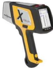
Şekil 3.52. Batman Üniversitesi Arkeometri Ana Bilim Dalında kullanılan P-EDXRF
