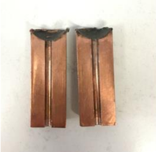
Şekil 6.4. Emme döküm yöntemi için kullanılan bakır kalıp
