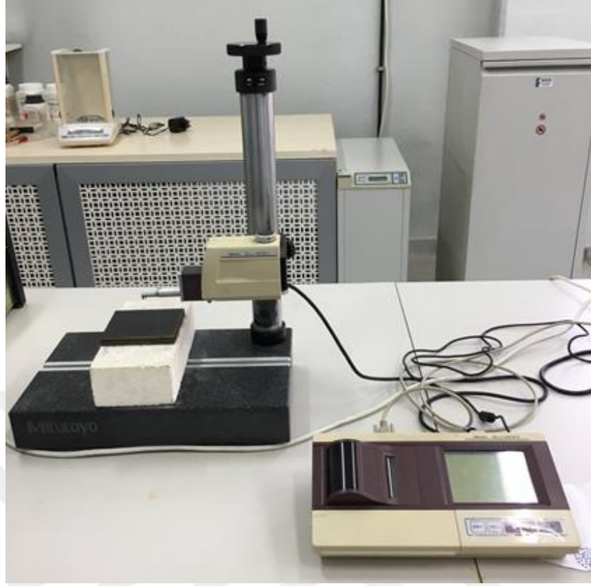
Şekil 6.8. Aşınma derinlikleri ölçümü için kullanılan profilometre
