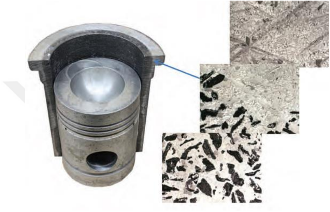
Şekil 4.13. UWM kompozit malzeme merkezinde üretilen piston, silindir gömleği ve mikroyapıları [67]
