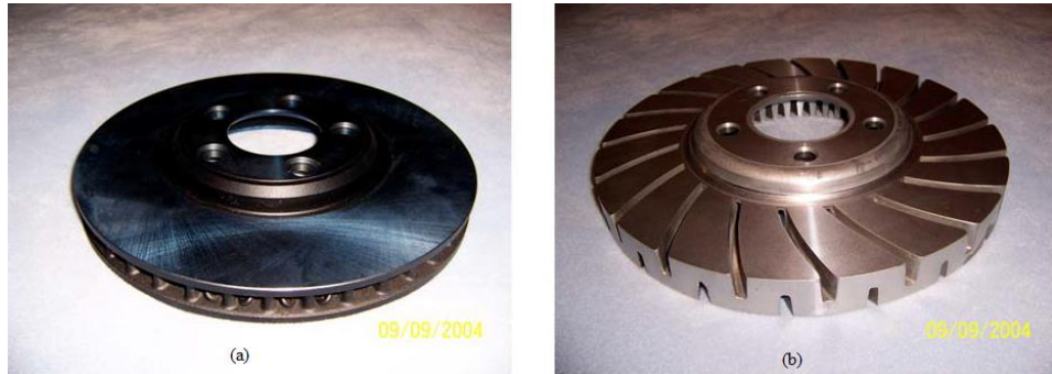
Şekil 4.14. a) Gri dökme demirden üretilen fren diski b) Al/SiC alüminyum matrisli kompozitten üretilen fren diski [68]
