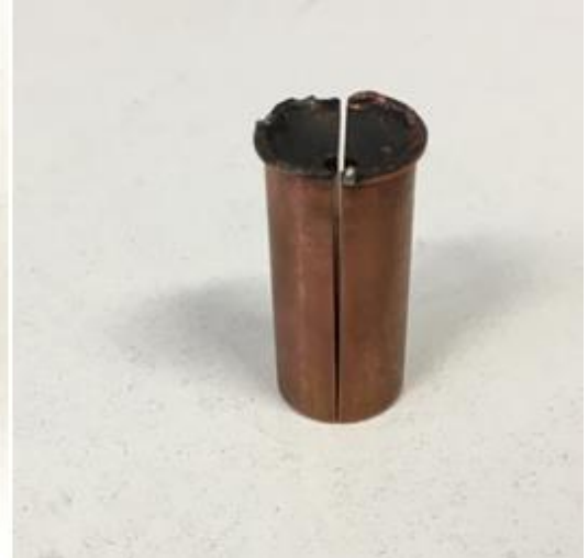
Şekil 6.4. Emme döküm yöntemi için kullanılan bakır kalıp
