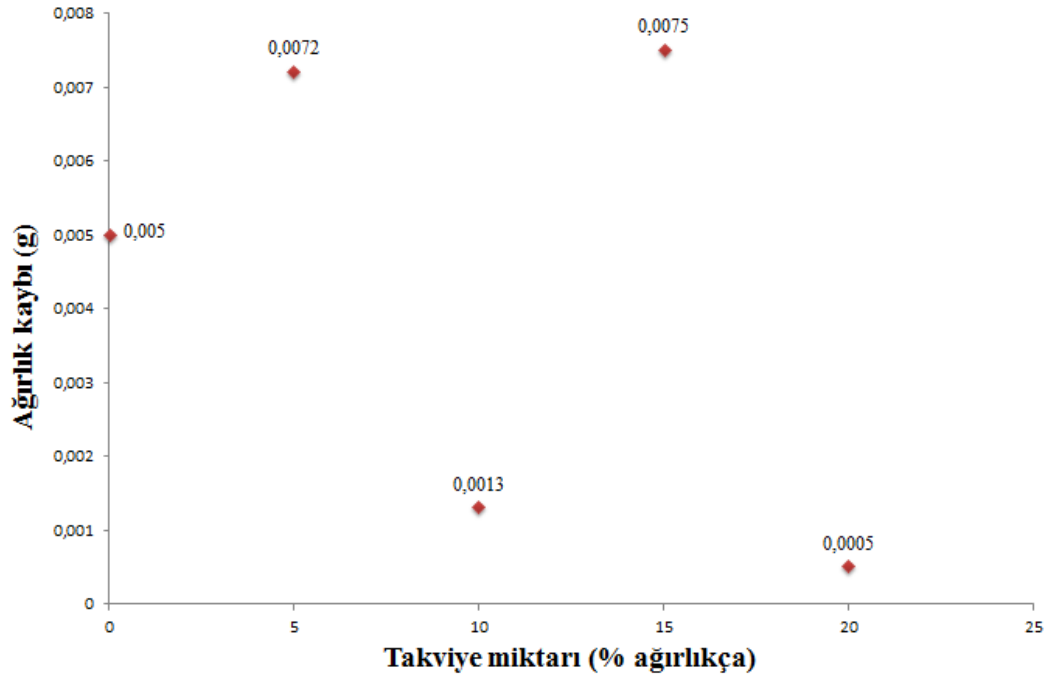
Şekil 7.17. SPS ile üretilen farklı takviye oranlarına sahip kompozitlerin aşınma testi sonrası ağırlık kayıpları
