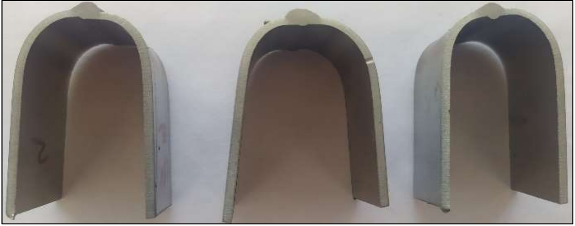
Resim 6.17. %98,5 Ar + %1,5 H 2 koruyucu gazı ile birleştirilmiş ve üç nokta eğme testi gerçekleştirilmiş numunelerin resimleri
