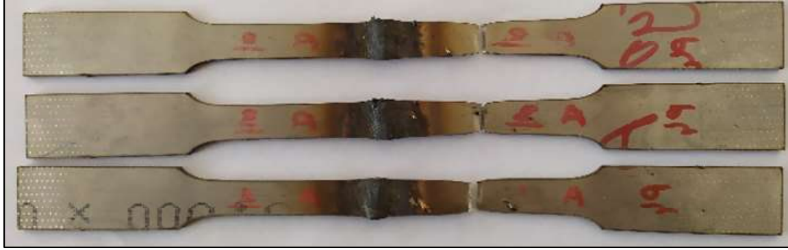
Resim 6.13. Saf argon koruyucu gazı ile birleştirilmiş ve çekme testi gerçekleştirilmiş numuneler
