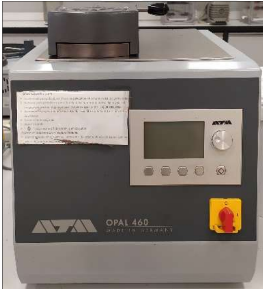
Resim 5.4. ATA marka Opal 460 sıcak bakalit cihazı resmi
