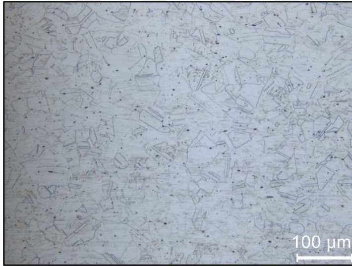
Resim 2.1. Östenitik çeliğin mikro yapısı
