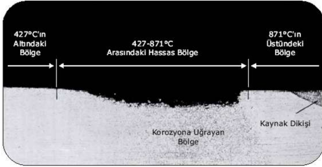
Resim 3.2. Krom karbür çökmesi sonucu hassas bölgede oluşan korozyon [27]
