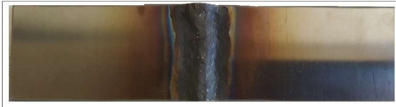
Resim 5.12. Kesimi gerçekleştirilen üç nokta eğme numunesi
