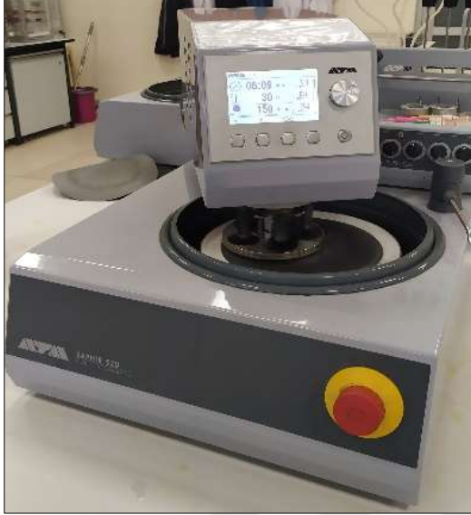
Resim 5.5. ATA marka saphir 520 zımparalama parlatma cihazı resmi
