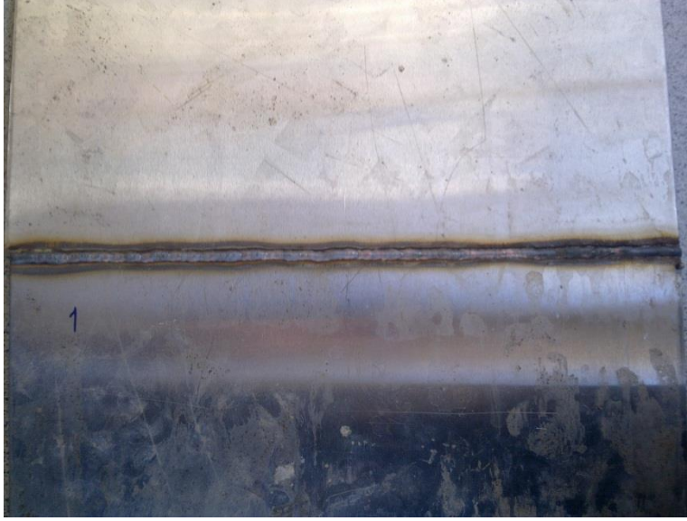
Şekil 3.2. Boyutları Şekil 3.1’de verilmiş levhaların kaynak edilmiş durumu
