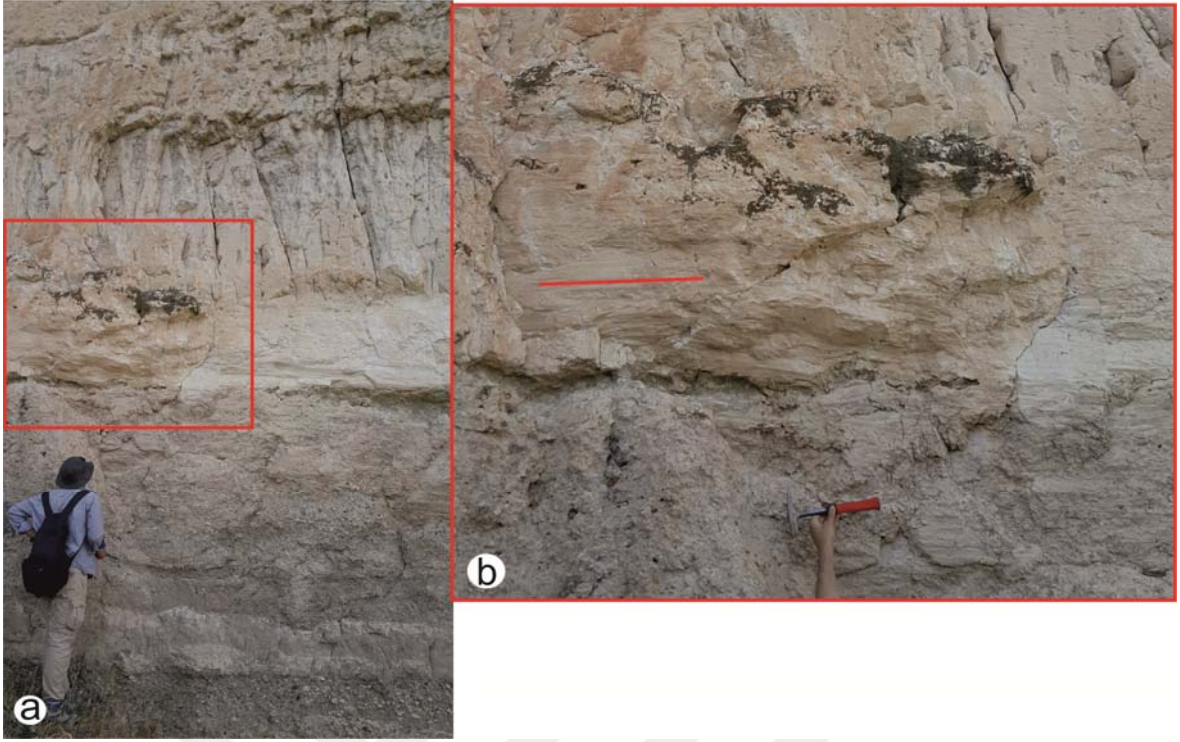
Şekil 3.50. Pliyosen yaşlı karbonatlı birimleri kesen faya ait görüntüler, a) düzlemin uzaktan görünümü, b) düzlem yakından görülmektedir, çekiç çiziklere paralel olarak durmaktadır.
