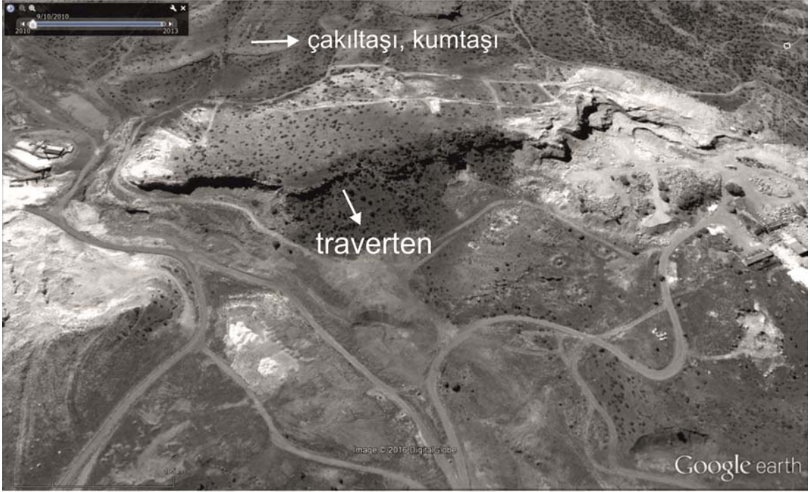
Şekil 3.62. Günümüzde işletilmiş olan traverten çökelinin işletilmeden önceki tarihte alınan bir uydu görüntüsünde doğrultusunun yaklaşık D-B olduğu görülmektedir.
