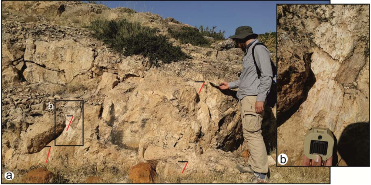
Şekil 3.24. a) Eğim atımlı normal bileşene sahip fayın uzaktan görünümü, siyah çizgiler düzlemin doğrultusunu gösterirken kırmızı çizgiler fay çiziklerine paraleldir. b) Düşeye yakın fay çiziklerinin yakından görünümü.
