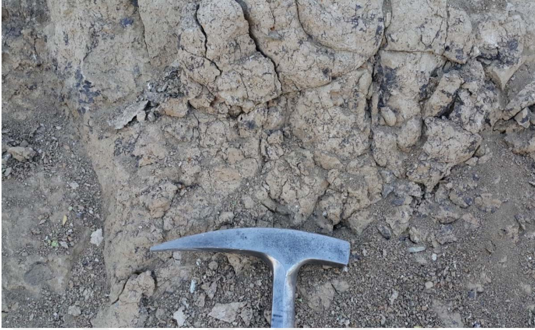
Şekil 3.43. Yan kayaçta faylanmayla ilişkili mangan saçınımları (siyah kısımlar mangan mineralleridir).
