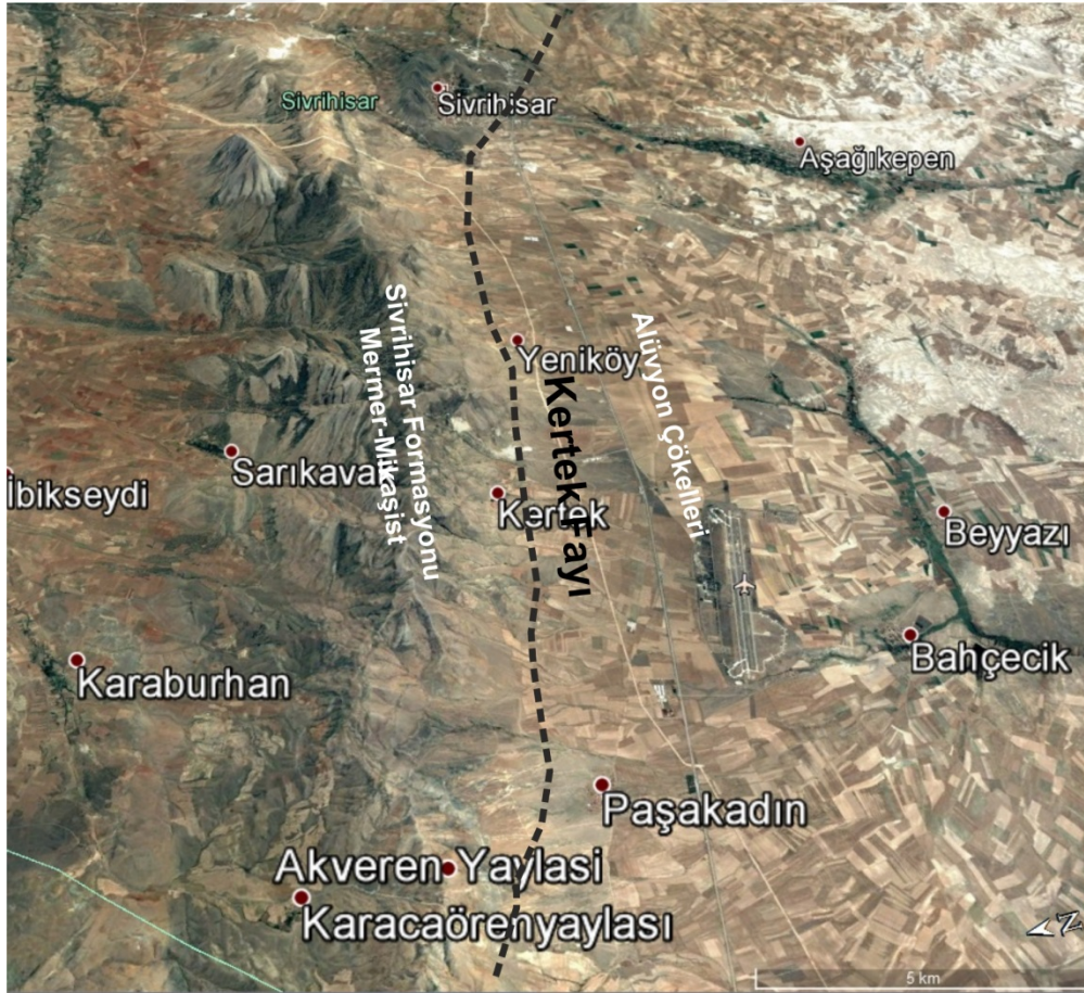
Şekil 3.55. Kertek Fayı'nın Sivrihisar'dan doğuya doğru uzanan bir hat boyunca mermerler ve alüvyon çökellerini biraraya getirdiği görülmektedir.
