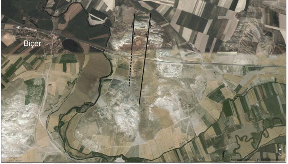
Şekil 3.51. Biçer kuzeydoğusunda bulunan fayların uydu görünümü. Fayların yaklaşık K-G doğrultulu olduğu ve birbirlerine paralel oldukları görülmektedir.
