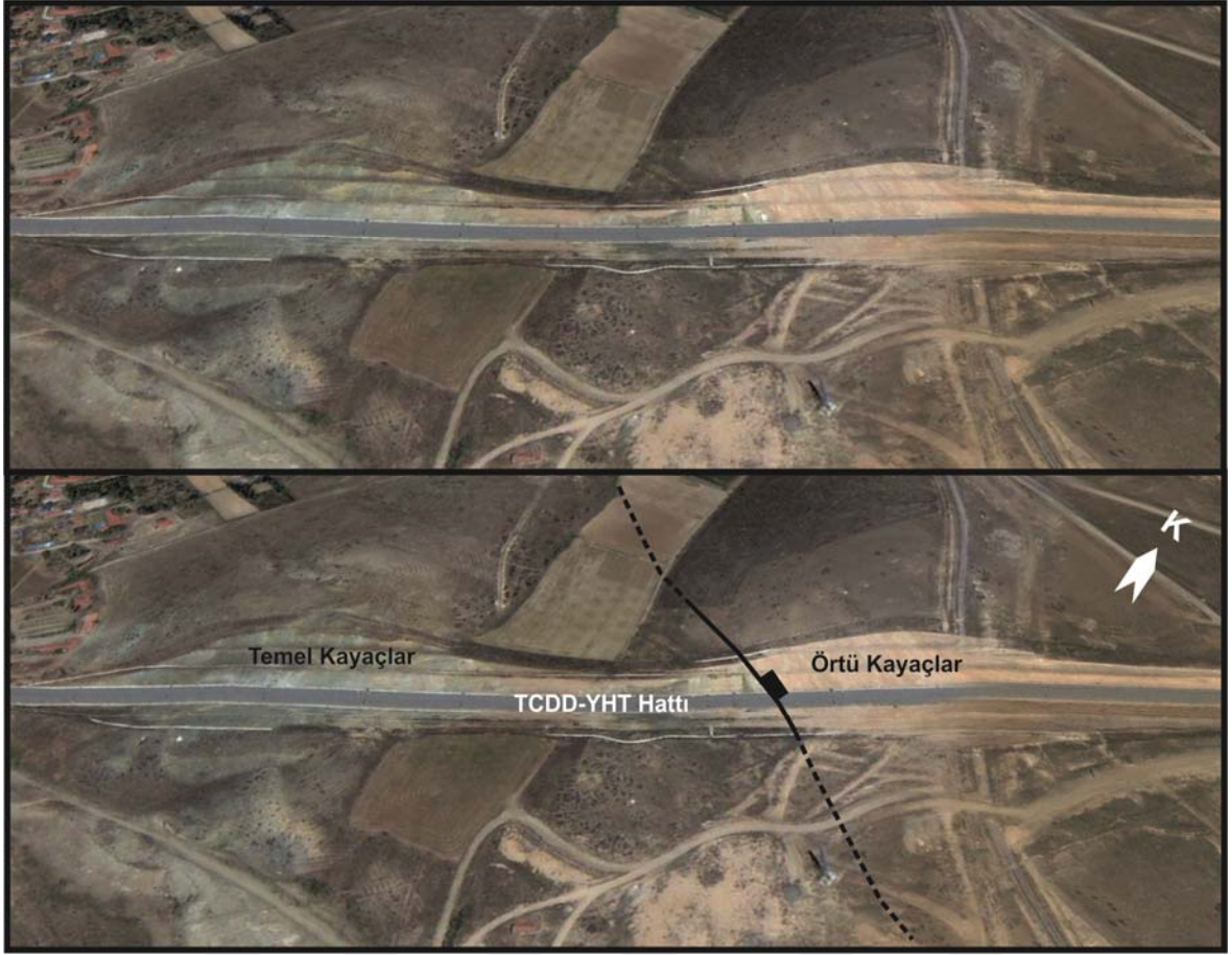
Şekil 3.10. YHT hattının KD-GD gidişi görülmektedir (Yunus Emre Köyü güneydoğusu). Yeşilimsi görülen kısımlar temel kayaçlar, açık renkli kısımlar ise Pliyosen yaşlı örtü birimlerdir. Görüntünün yorumlanmış hali için şekil 3.11'e bakınız.
