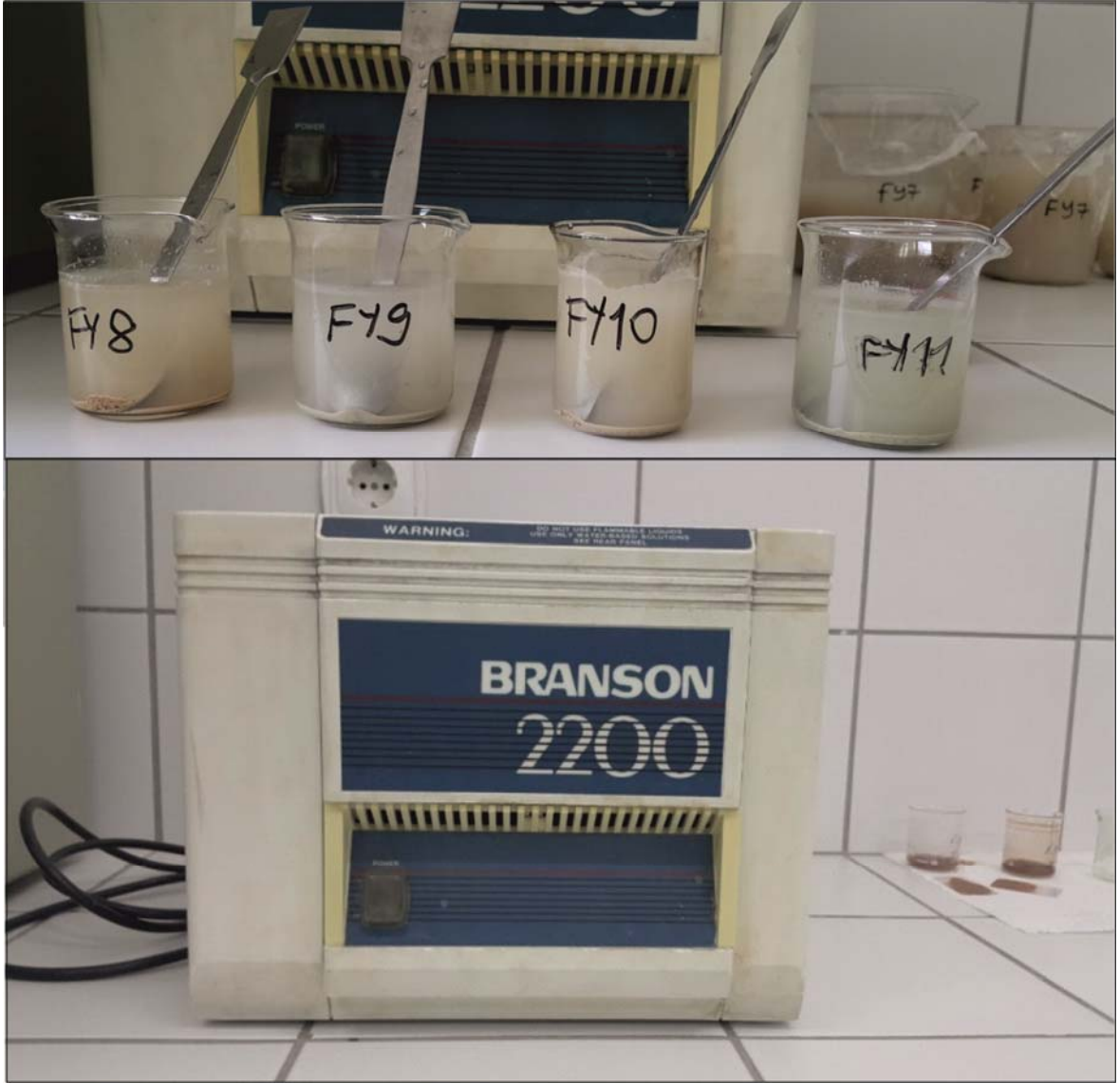
Şekil 1. Ezilen örnekler saf suya konularak ultrasonik havuza yerleştirilir. Birbirine yapışan minerallerin titreşimle ayrılması sağlanır.
