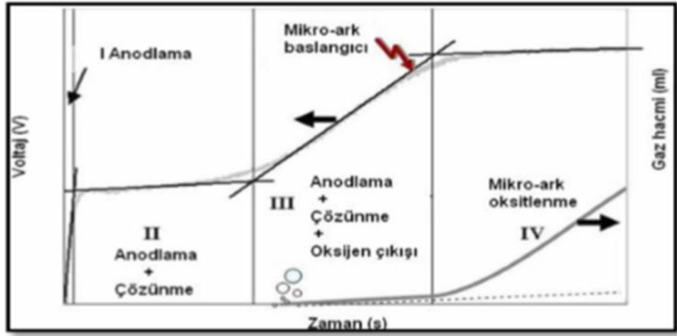
Şekil 3.2. MAO işleminin basamakları [14].
