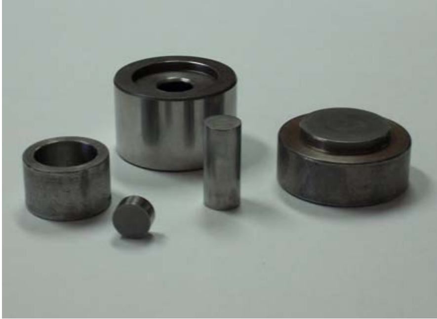
Şekil 5.2 Şekillendirme kalıpları ve parçaları görülmektedir.
