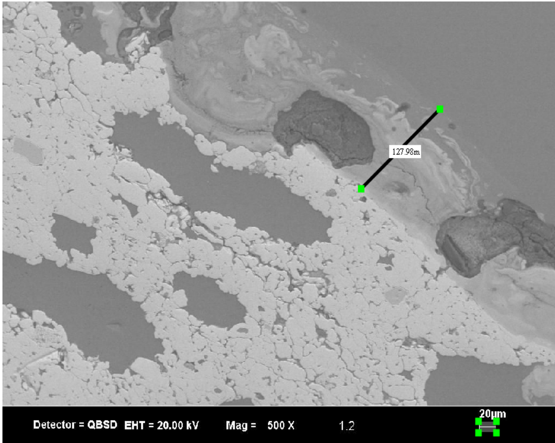
Şekil 6.24 Fe-50Al -Al saplama kaynak arayüzeyi (100V)
