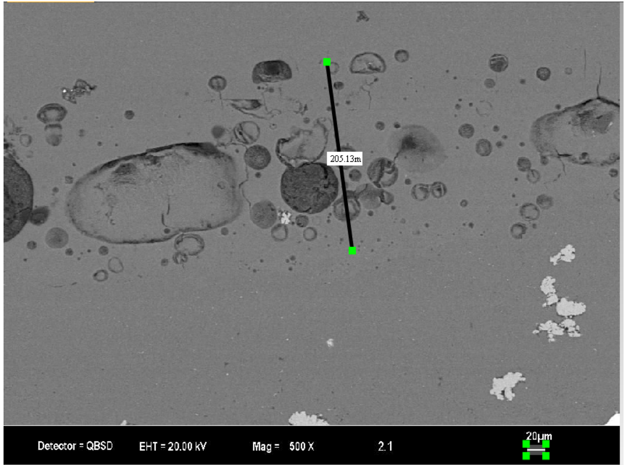
Şekil 6.1 Fe-26Al –Fe saplama kaynak arayüzeyi (100V)
