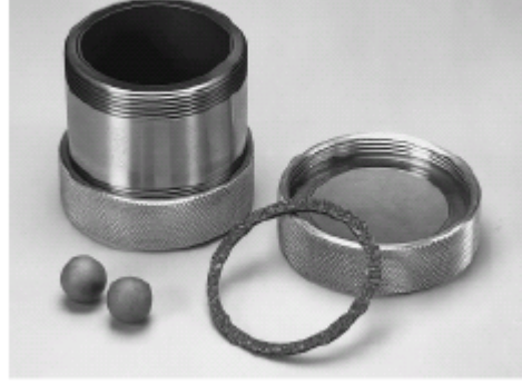
Şekil 2.5 Tungsten karbür’ den yapılmış SPEX tipi karıştırıcının; öğütme kabı, kapak, conta ve bilyalardan oluşan öğütme hücresi (Suryanarayana, 2001).
