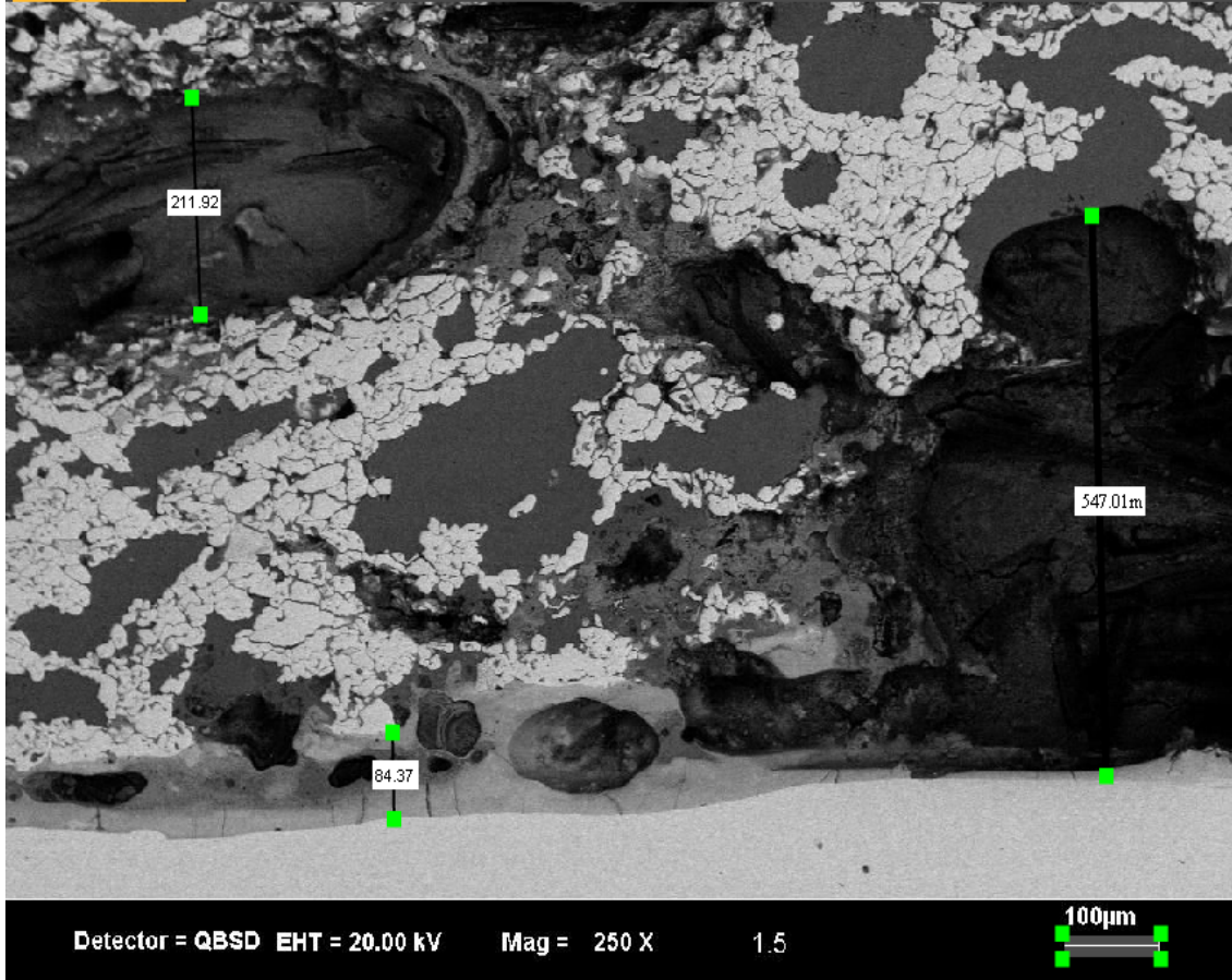
Şekil 6.13 Fe-50Al - Fe saplama kaynak arayüzeyi (150V)
