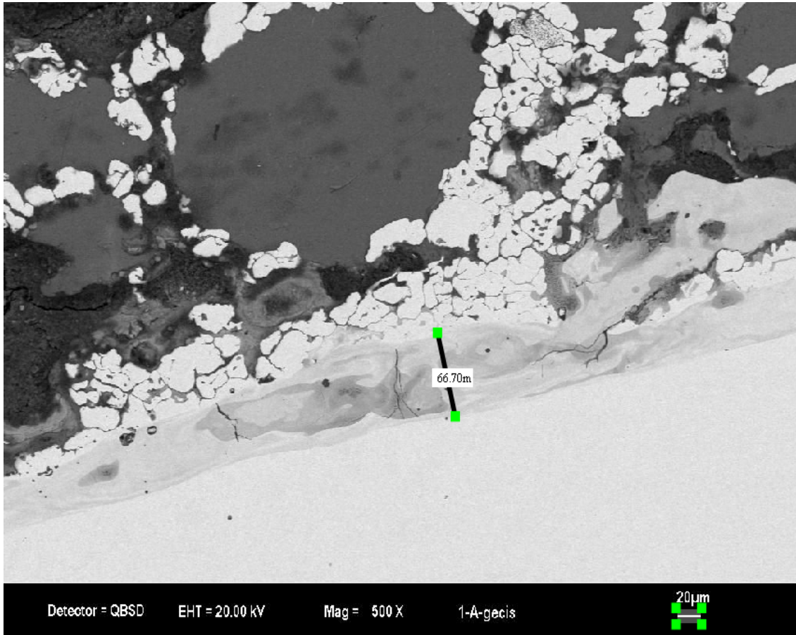
Şekil 6.11 Fe-50Al –Fe saplama kaynak ara yüzeyi (140V)
