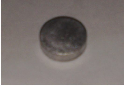
Şekil 5.3 Deneysel çalışmalarda kullanılan numunelerin şekli ve boyutu.
