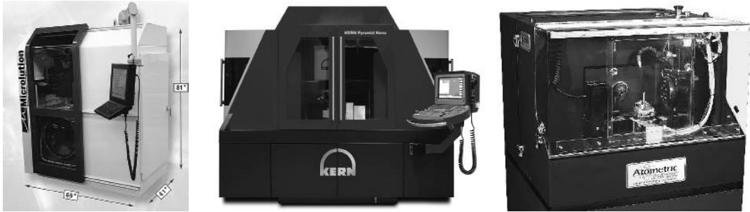
Resim 2.13 Ticari kulvarda kullanılan mikro freze tezgâhları (İnt. Kyn.4)
