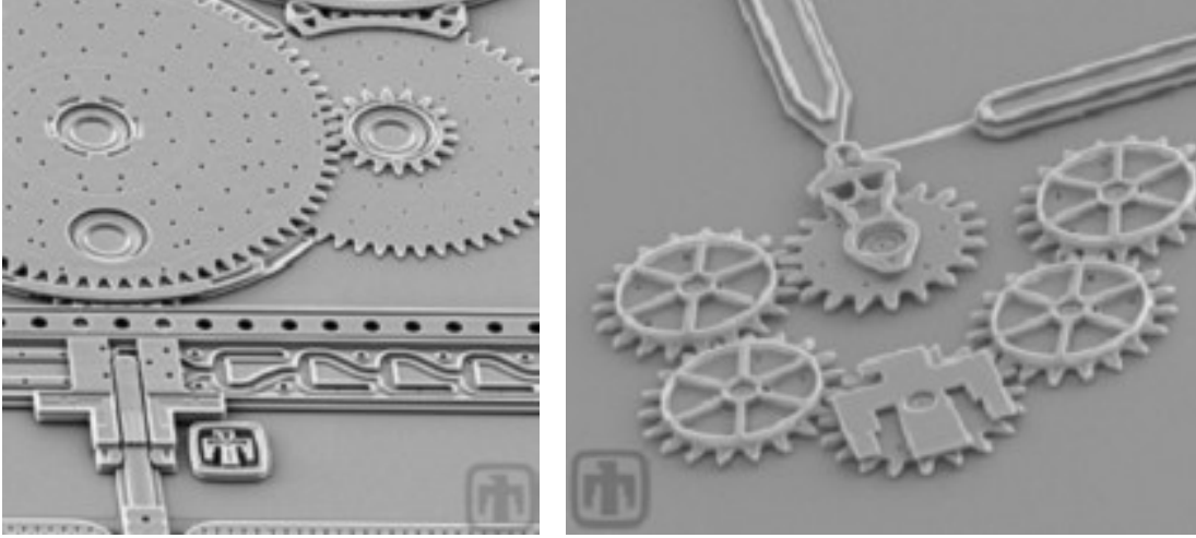
Resim 2.8 Silisyum yüzey mikro-işleme tekniğiyle üretilmiş elektro statik mikro motor sistemi (İnt. Kyn.1).
