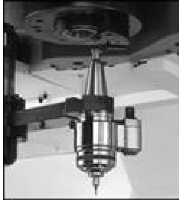
Resim 2.14 Pnomatik destekli anahtarsız mandren tutuculu iş mili (İnt. Kyn.5).
