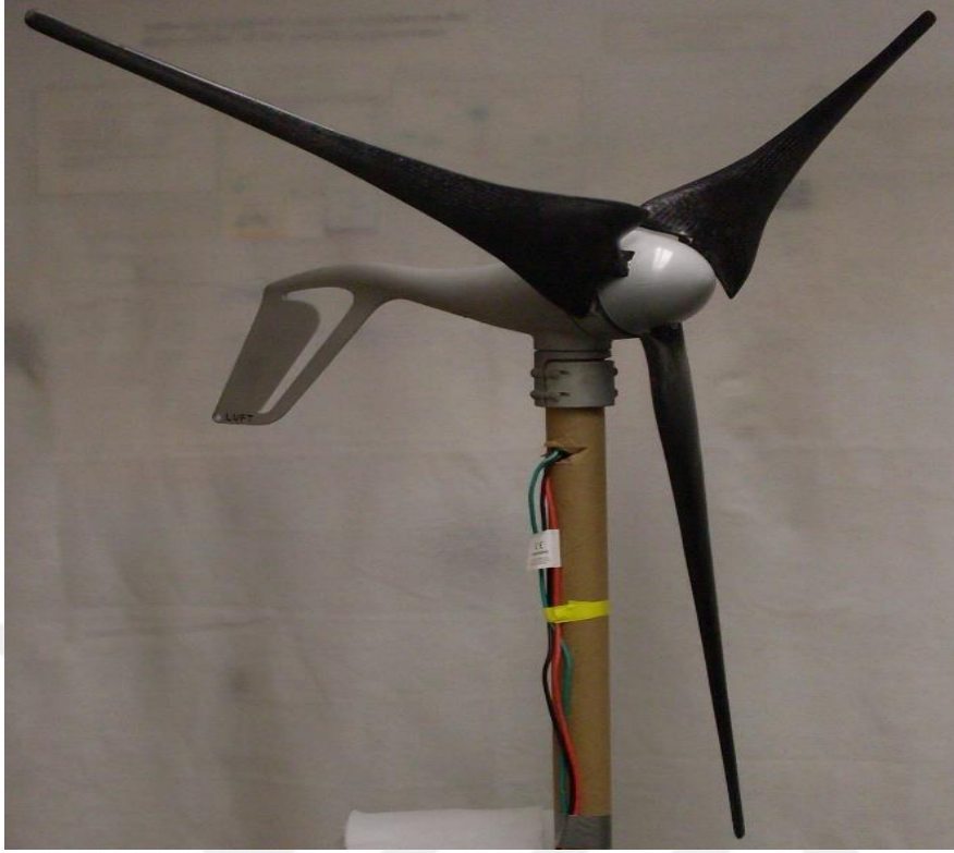
Şekil 1. 7. Karbon nanotüp ile güçlendirilmiş rüzgâr türbini (Case Western Reserve University, 2011.)
