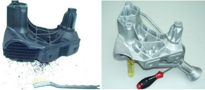
Şekil 4.8 Termojet yöntemiyle elde edilmiş model ve bu modelin harcanması sonucuyla hassas döküm ile elde edilmiş parça [26]
