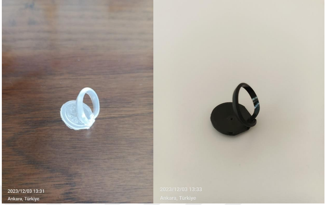
Resim 26. Sıvı yağ plastik şişe kapağı açma aparatı (Sol). Sirke plastik şişe kapağı açma aparatı. (Sağ).
