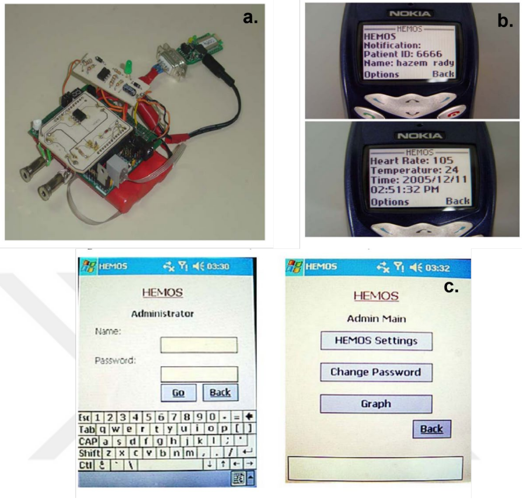
Şekil 2.35: Sagahyroom, A ve ekibinin geliştirmiş olduğu sıcaklık ve kalp atışını izleyen mikrodnetleyici temelli giyilebilir cihaz (a.), parametrelerin yüksek olması durumunda SMS ile bilgilendirme sistemi (b.) ve verilerin izlenebildiği web arayüzü (c) [105].
