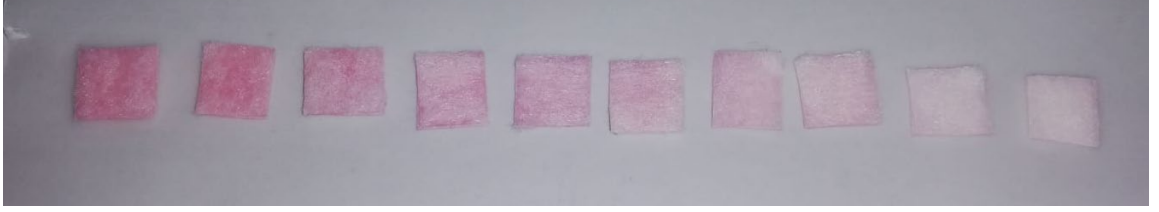
Şekil 4.4: Sırasıyla 50, 40, 30, 20, 10, 5, 2, 1, 0,8, ve 0,4 ug/mL konsantrasyonda kortizol ile renk reaktif bölgelerinin renk değişimini gösteren şekil.
