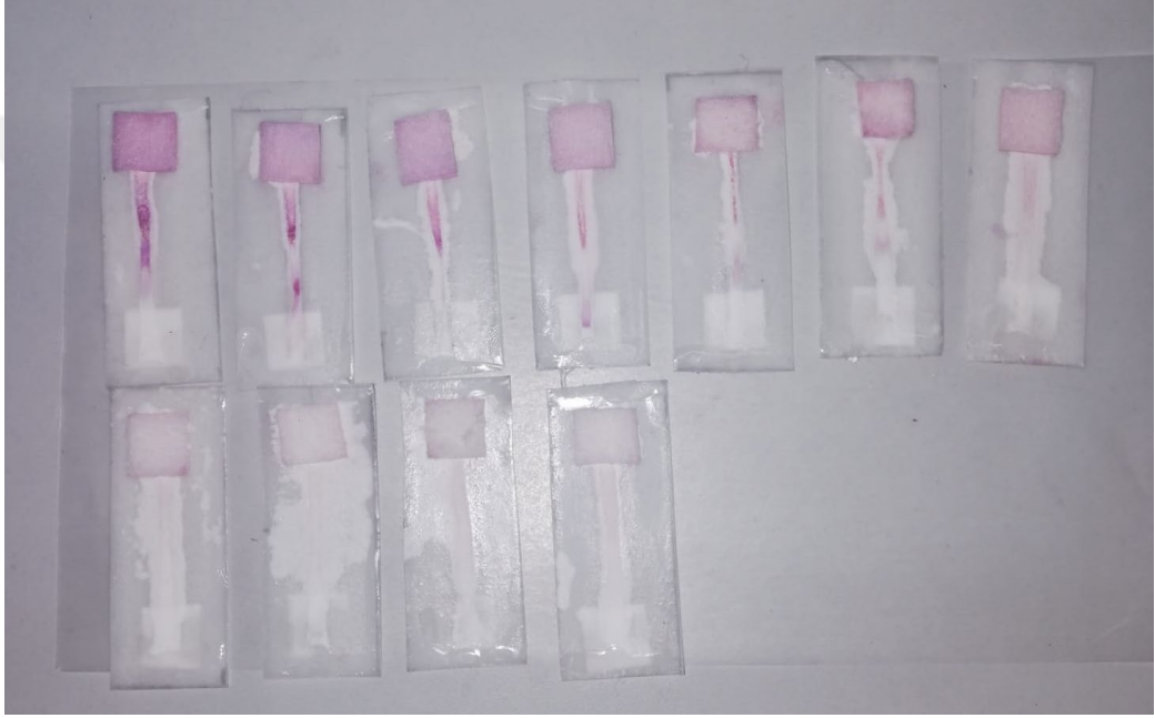
Şekil 4.5: Hidrofobikleştirilerek kanallanmış mikroakışkan tabakaların ter emici bölge ve reaktif bölgeler ile birleştirilerek Sırasıyla 50, 40, 30, 20, 10, 5, 2, 1, 0,8, 0,4 ve 0,2 ug/mL’lik konsantrasyonlarda kortizol ile reaksiyonu sonucunda ortaya çıkan renk ve mikroakışkan sistemi gösteren şekil.
