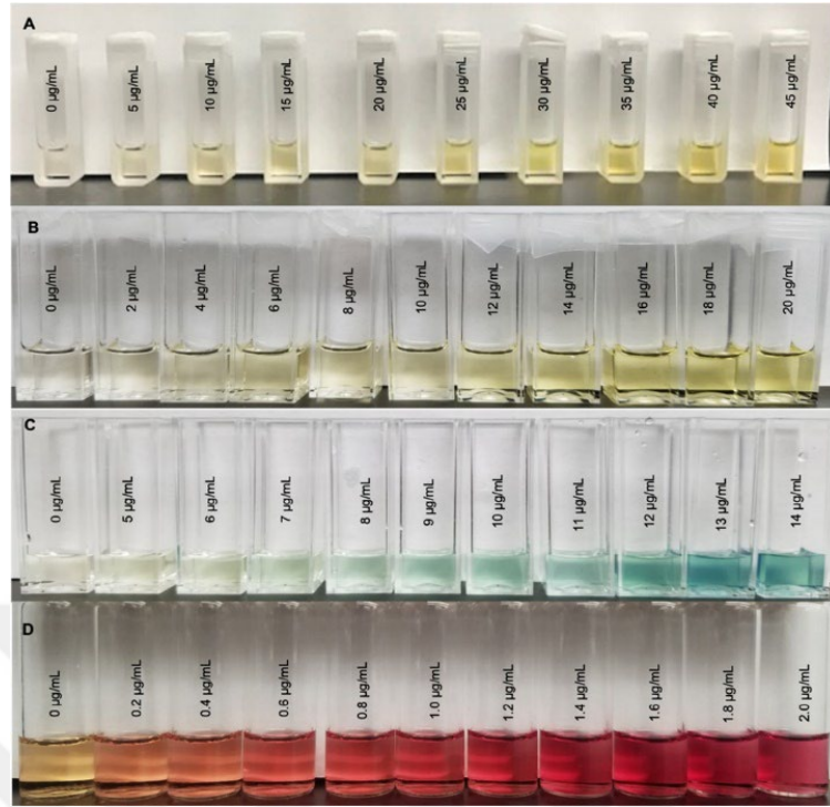
Şekil 2.10: Kolorimetrik kortizol hormonu tespiti için farklı yöntemlerden alınan renklerin gösterimi. (a) Sülfürik asit yöntemi (b) Altın nanopartiküle bağlı Silber-Porter yöntemi (c) Prusya mavisi yöntemi (d) Mavi tetrazolyum yöntemi [51].
