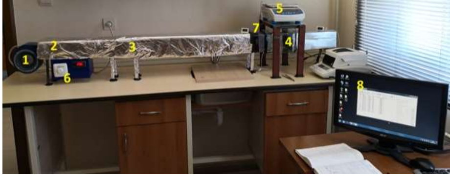
Şekil 3.3. Tünel tipi kurutucu görüntüsü. (1-Fan 2-Rezistans bölgesi 3-Hidro dinamik geçiş bölgesi 4-Terazi Bölgesi 5-Terazi 6-Kontrol paneli 7- Dijital Termometre 8-Bilgisayar)
