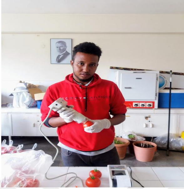
Şekil 3.8. Domates meyvelerinde renk ölçümü
