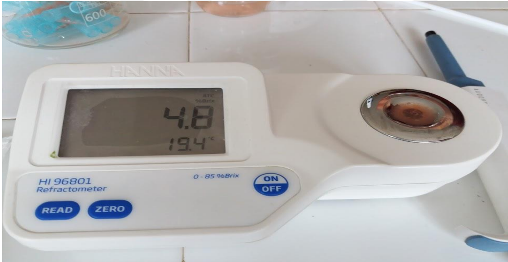
Şekil 3.13. Dijital refraktometre ile SÇKM miktarı ölçümü
