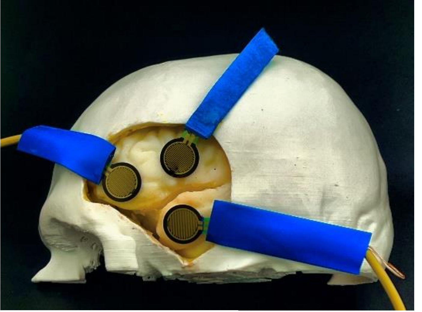
Resim 7: Sensörler yerleştirilmiş parankim modeli
