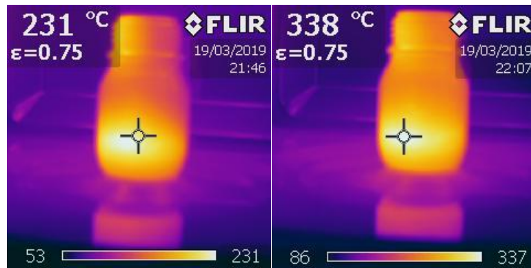
Şekil 10.48 800 watt seviyesinde, 5. (Solda) ve 30. dakika da (Sağda) numunelerin ulaştığı sıcaklık seviyelerinin termal görüntüsü (Kişisel arşiv, 2019)
