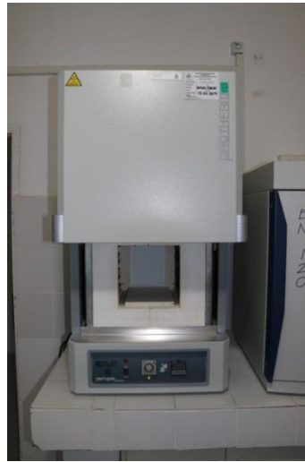
Şekil 10.2 Kolemanit ve üleksit cevherlerinin konvansiyonel ısıtma işlem deneylerinde kullanılan metalurjik fırın (Kişisel arşiv, 2019)
