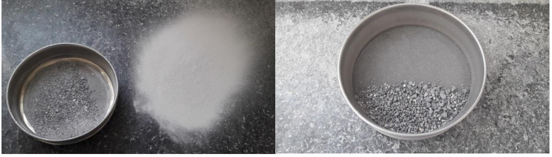
Şekil 10.7 Konvansiyonel ısıt işlem sonrası kolemanit elek üstü ve elek altı görüntüsü (Kişisel arşiv, 2019)
