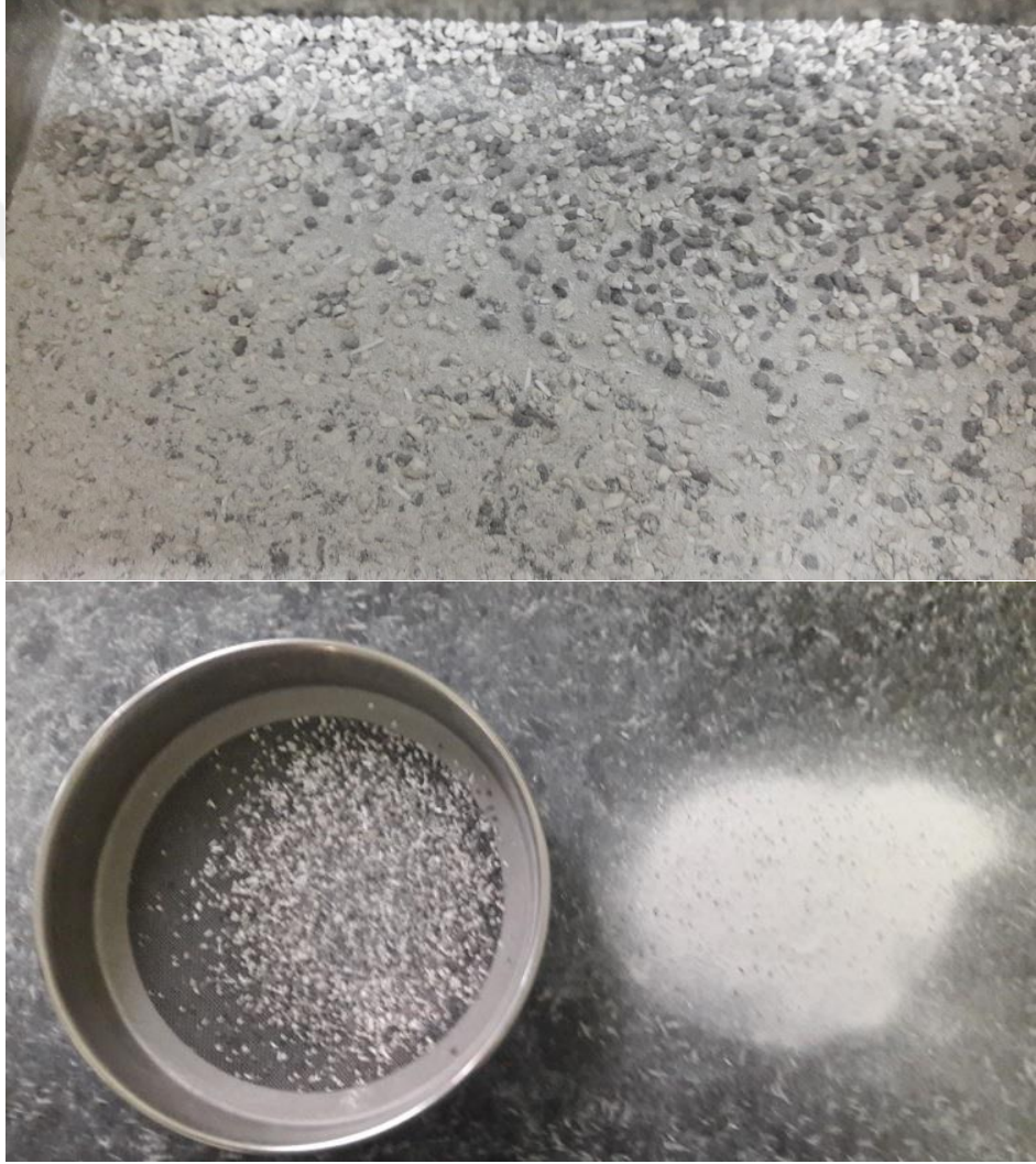
Şekil 10.38 Üleksit numunelerinin konvansiyonel ısıtıl işlem sonrası elek üstünde parçalanmamış üleksit tanelerinin elenmeden önce ve sonra görüntüntüleri (Kişisel arşiv, 2019)
