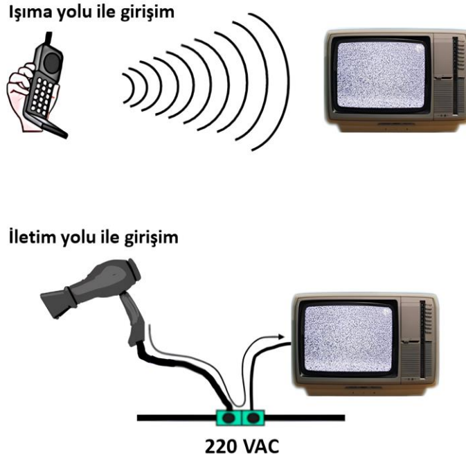
Şekil 3. Işıma yolu ve iletim yolu ile elektromanyetik girişim örnekleri
