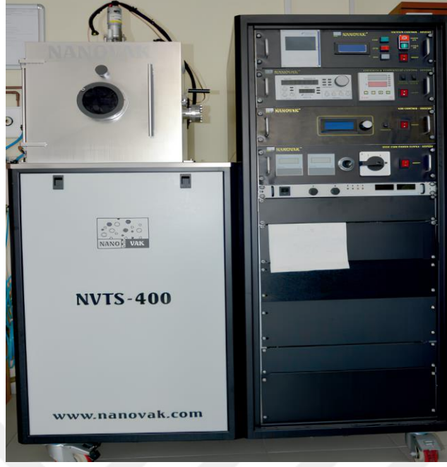
Şekil 16. Nanovak marka NVTS-400 model ince film kaplama cihazı
