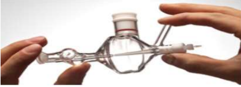
Şekil 1.10. Çok modlu örnek giriş sistemi (MSIS) ve sprey odası
