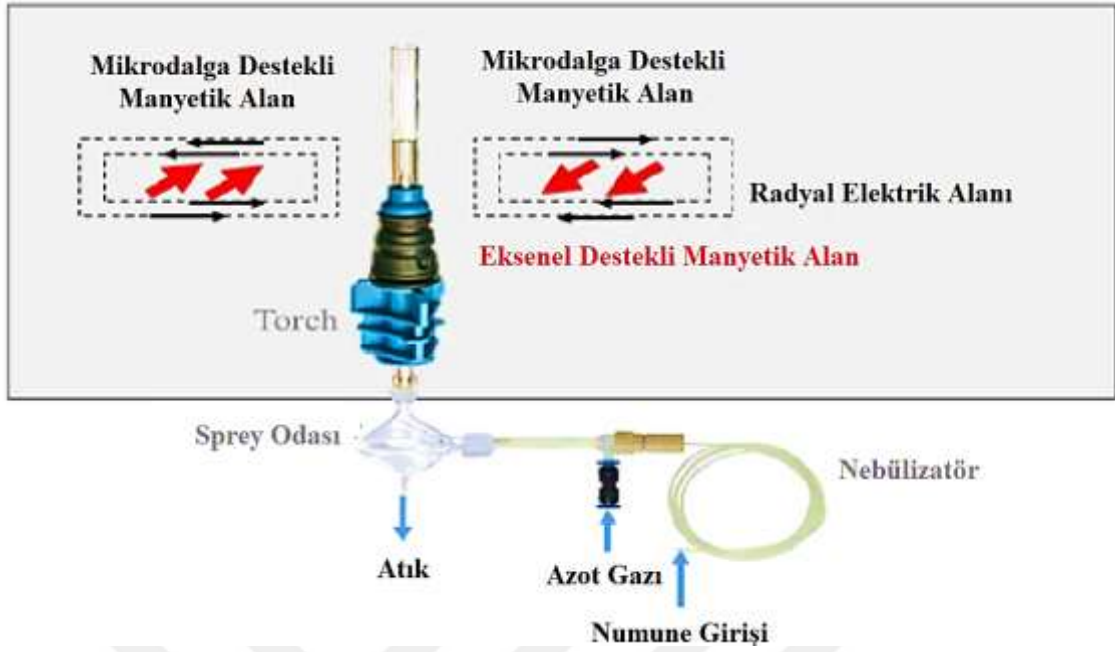
Şekil 1.8. MP-AES’de plazmanın oluşturulduğu torch’un genel yapısı
