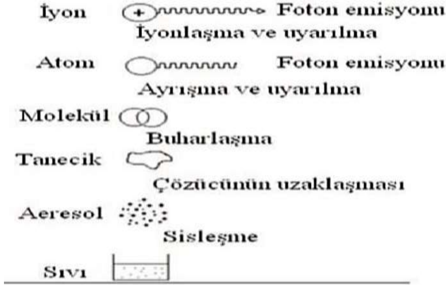
Şekil 1.4. Atomlaşma ve uyarılmanın şematik gösterimi
