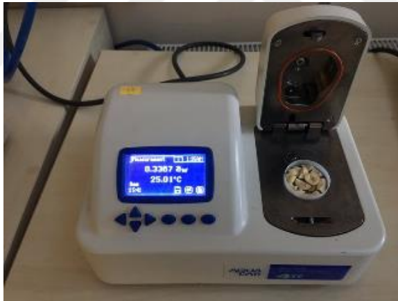
Şekil 3. 54. Aqualab 4TE Su Aktivite Cihazı
