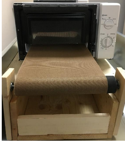
Şekil 3. 8. Mikrodalga Fırın Ön Metal Kesim Bölgesi
