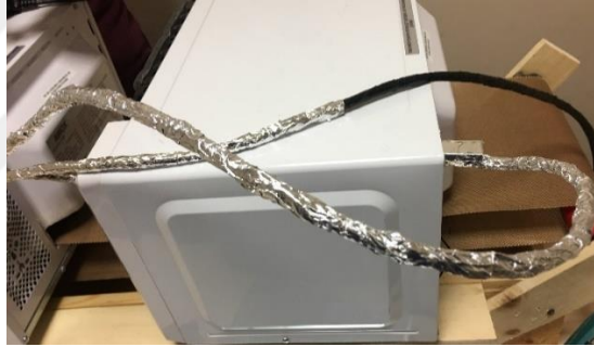
Şekil 3. 12. Mikrodalga Kablolarının Alüminyum Yapışkan Bant İle Sarılması
