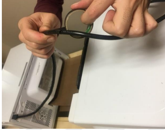
Şekil 3. 11. Mikrodalga Kablolarının Elektirik Bandı İle Sarılması
