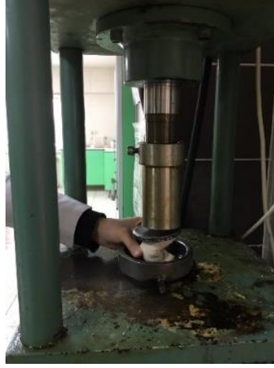
Şekil 3. 50. Bez İçerisine Yerleştirilmiş Toz Fındık Numunesinin Preslenerek Yağ Çıkarımı
