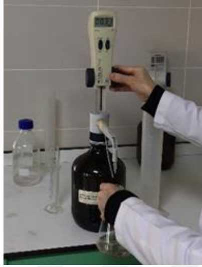
Şekil 3. 48. KOH İle Yapılan Titrasyon İşlemi
