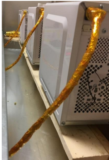
Şekil 3. 13. Mikrodalga Kablolarının Sıcaklığa Dayanıklı Bant İle Sarılması
