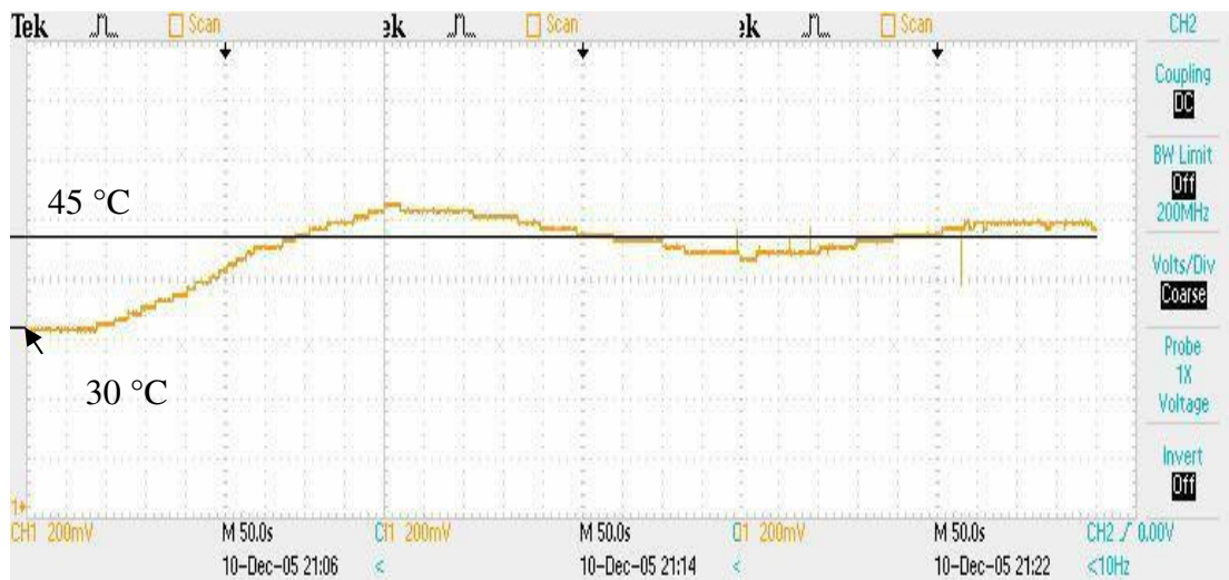
Şekil 5.17. Oransal+İntegral+Türevsel 30-45 °C, K_p=70 , K_D=5 , K_I=0,3
