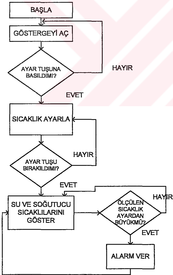
Şekil 4.14. Güvenlik devresi için hazırlanan yazılımın akış diyagramı
