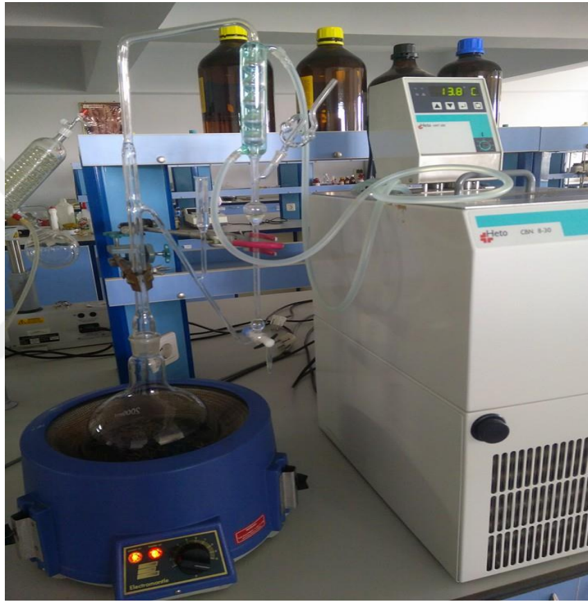
Şekil 3.3. Clavenger düzeneğinde su distilasyonu yöntemi ile biberiye uçucu yağının eldesi
