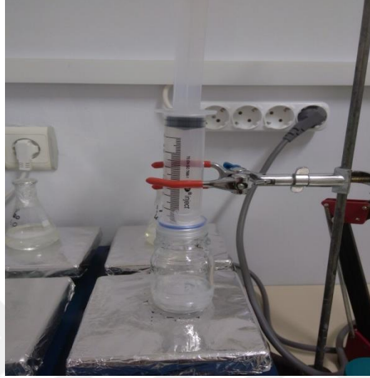
Şekil 3.7. Uçucu yağ/aljinat solüsyonunun \text{CaCl}_2 solüsyonuna damlatılması
