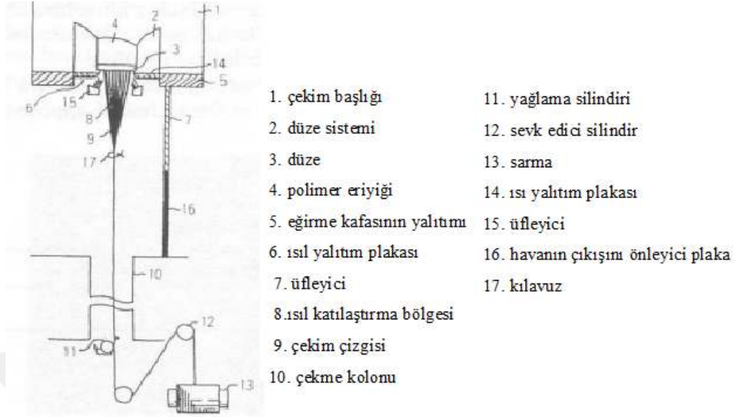
Şekil 1.3. Direkt lif çekim yöntemi (Gün ve ark., 2011)
