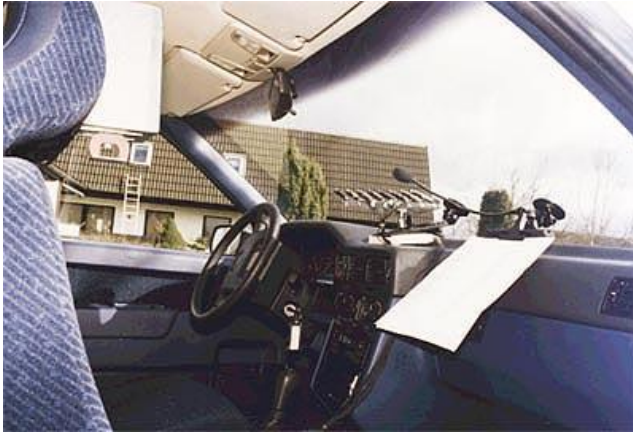
Resim 2.4. Araba ortamında eller serbest görüşme için mikrofon dizisi kullanımı [17]
