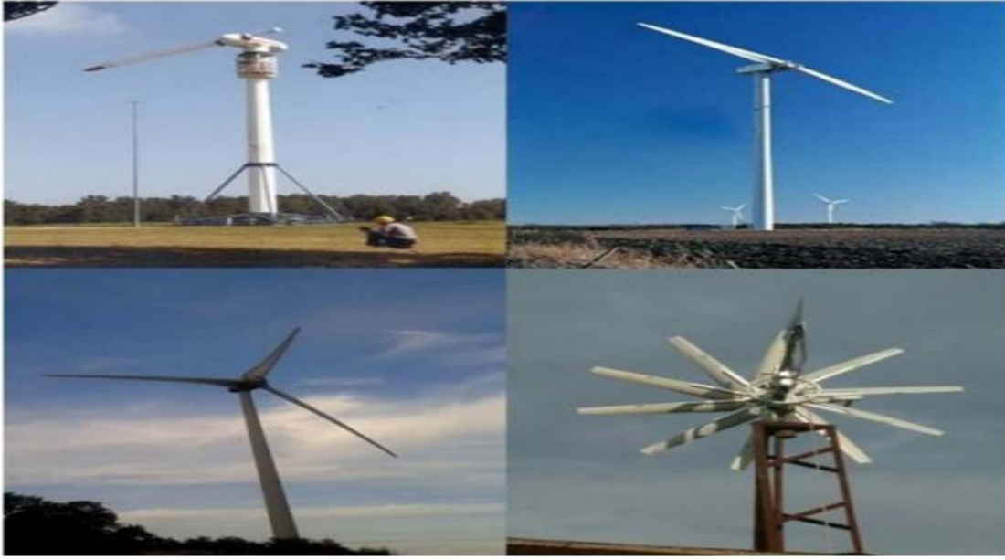
Resim 2.2 Rüzgârın gelme durumuna göre yatay türbin tasarımları(Hambarcı 2018).
