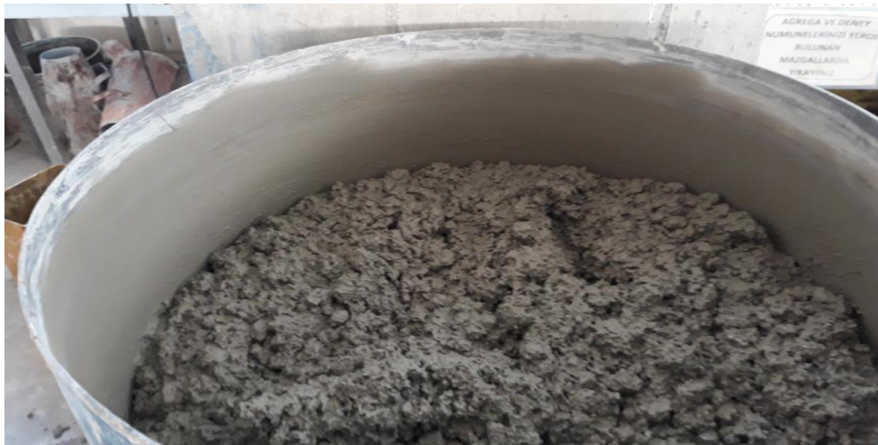
Resim 3.8. Beton karışımlarının hazırlanması
