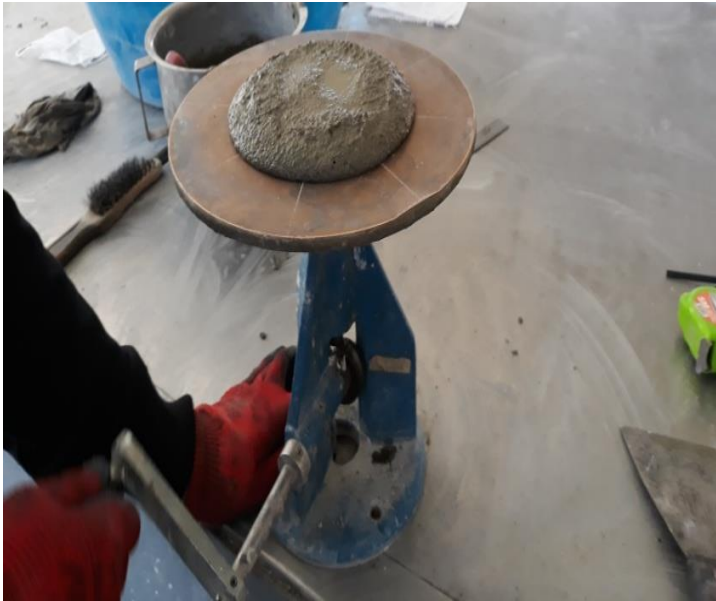
Resim 3.6. Hazırlanan harç numunelerine yapılan yayılma deneyi
