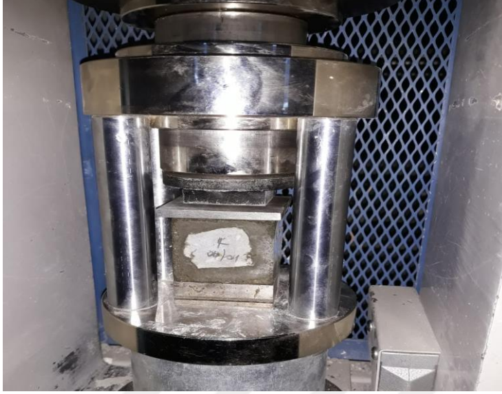
Resim 3.7. Hazırlanan harç numunelerine yapılan basınç deneyi
