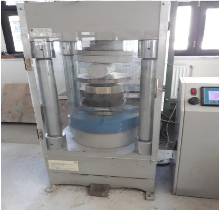
Resim 3.15. Beton silindir yarmada çekme deneyi
