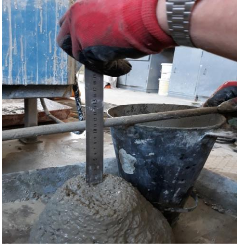
Resim 3.12. Hazırlanan beton numunelerine yapılan slump deneyi
