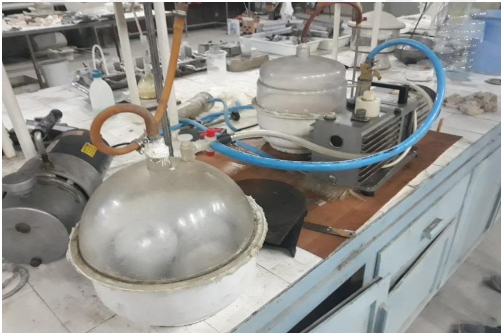
Resim 3.18. Kesilen numunelerin desikatöre yerleştirilmesi
