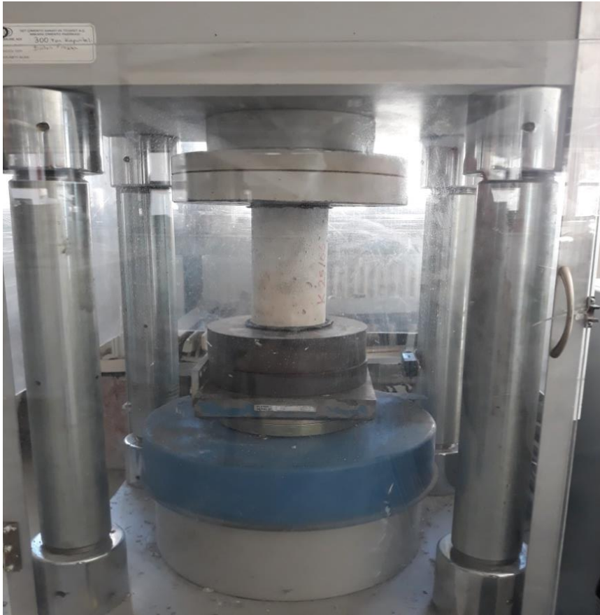
Resim 3.14. Beton silindir basınç deneyi (10x20 cm numune)
