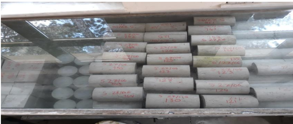
Resim 3.11. Kür havuzunda bekletilen beton numuneleri
