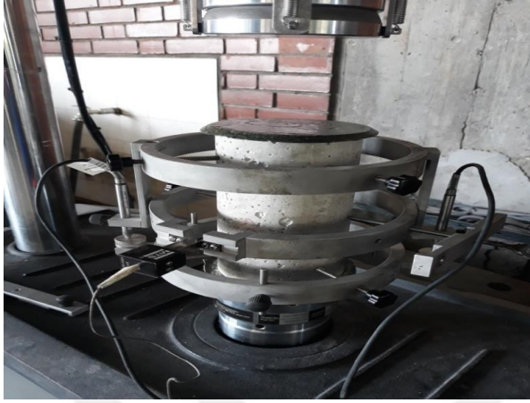
Resim 3.20. Numunenin elastisite modülü deneyine hazırlanması
