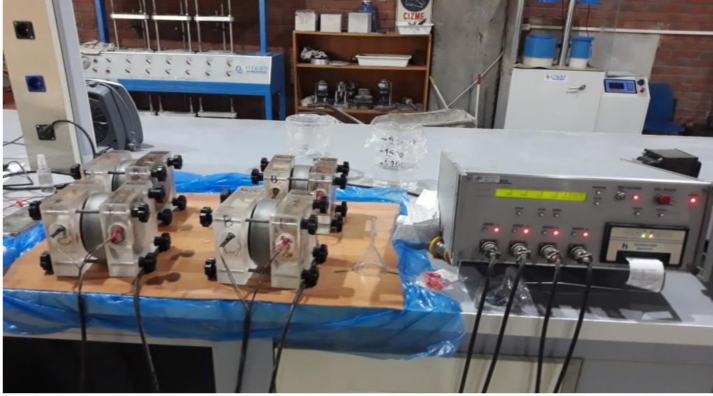
Resim 3.19. Klor-iyon geçirgenliği deneyi düzeneği
