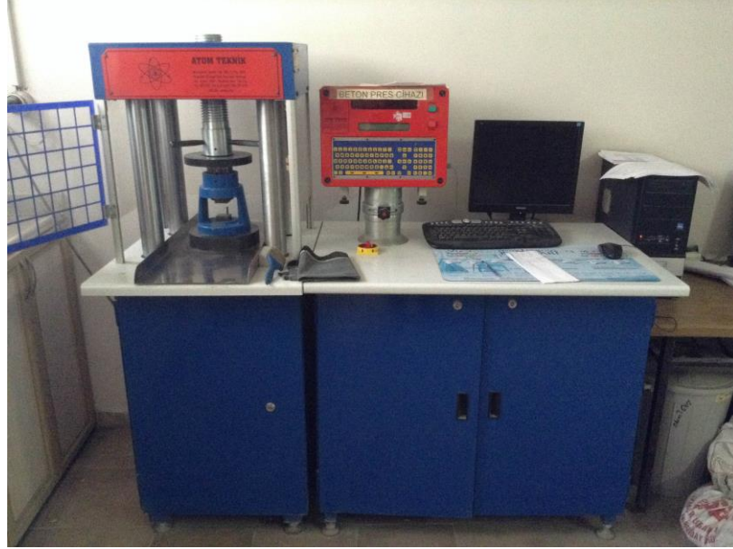
Şekil 3. 9. 2000 kN kapasiteli basınç cihazı
