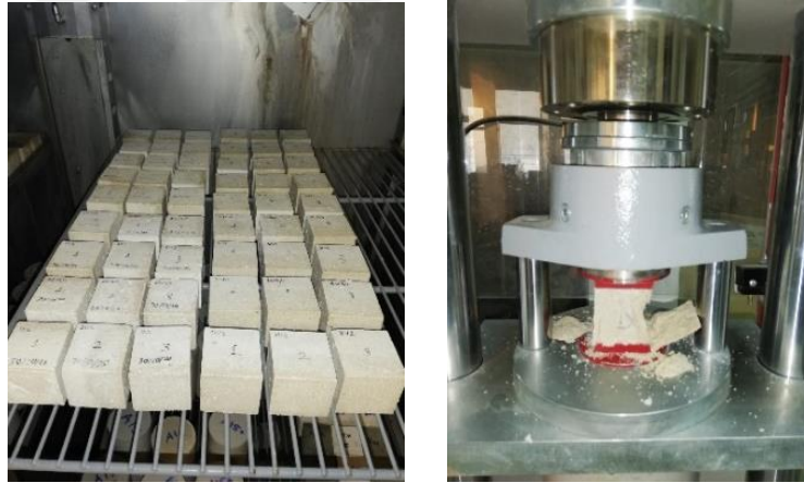
Şekil 3.11. Çimento harçları ve basınç dayanımı tayini.
