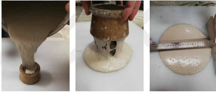
Şekil 3.20. UYPB yayılma çapı ölçümü.
