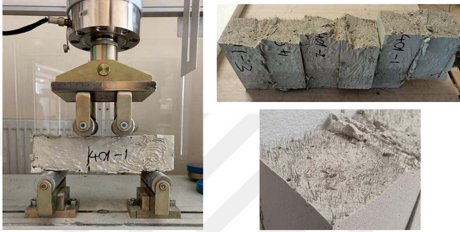
Şekil 3.25. UYPB eğilme dayanımı tayini.
