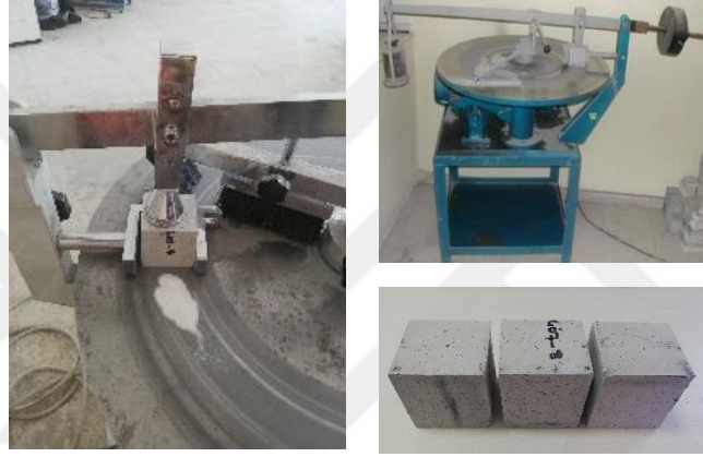
Şekil 3.31. Aşınma dayanımı tayini.
