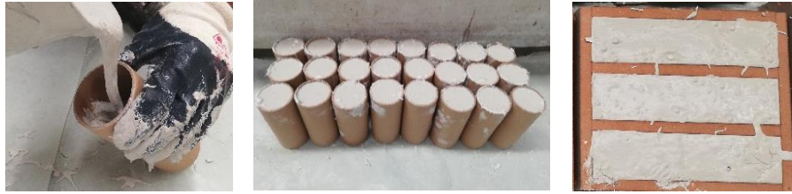
Şekil 3.18. UYPB kalıplara dökülmesi.
