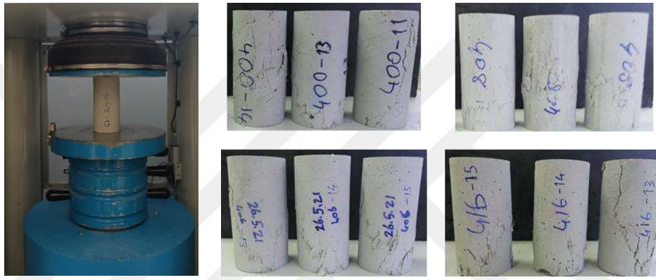
Şekil 3.24. UYPB basınç dayanımı tayini sonrası numuneler.
