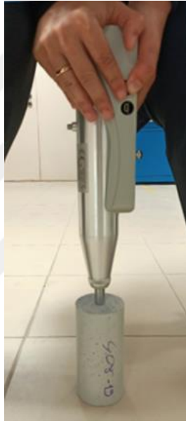
Şekil 3.26. Schmidt çekici uygulaması.
