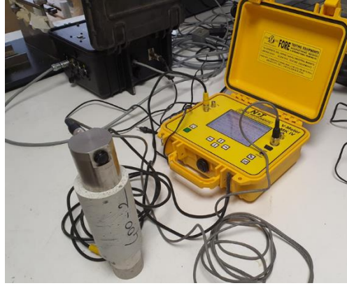
Şekil 3.27. Ultrases geçiş hızı test cihazı ve uygulaması.
