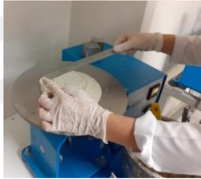
Akma tablası deneyi.
