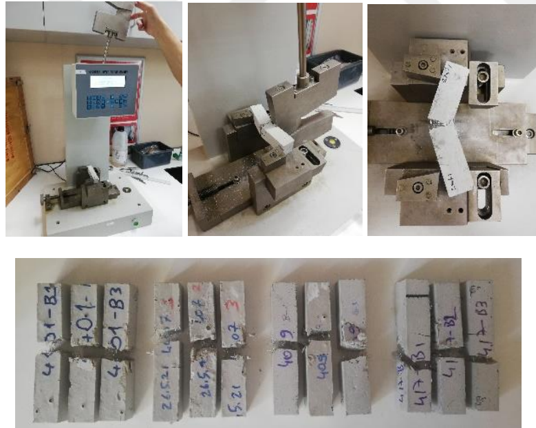
Şekil 3.28. Darbe dayanımı tayini ve numuneleri.
