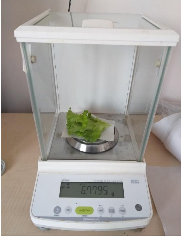
Resim 4.6. Fidelerin hassas terazide toprak üstü TA ölçümü
