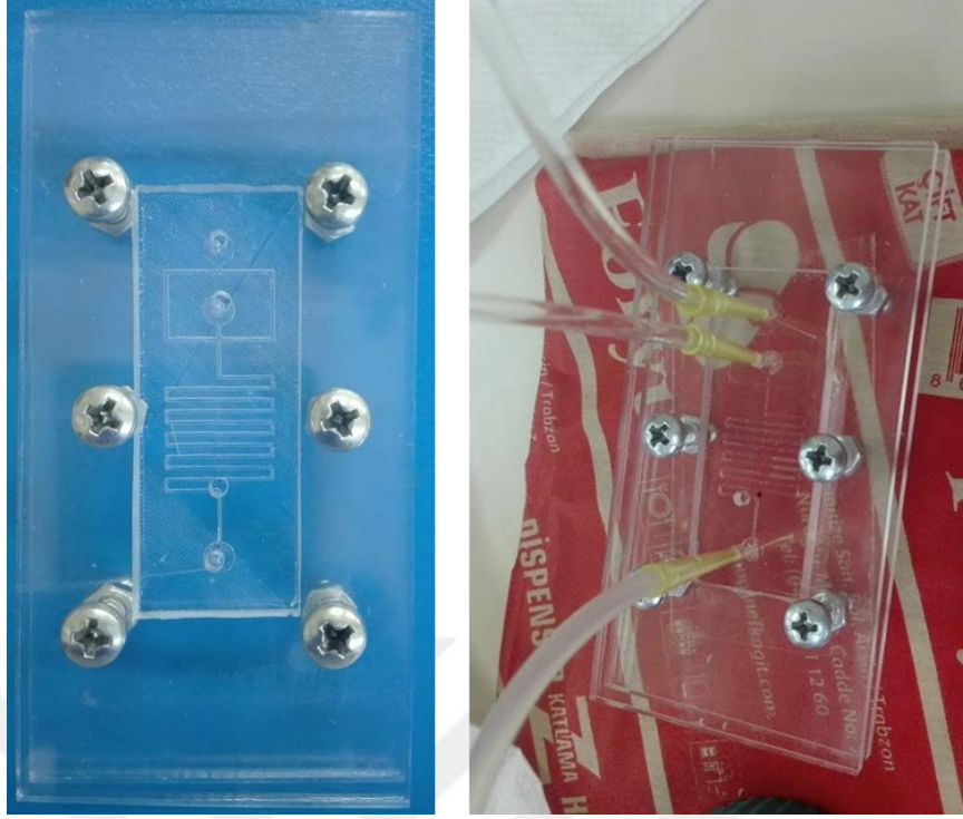
Şekil 5. 2. Pleksiglass levhaları ile sıkıştırılarak çalıştırılan mikroplatform
