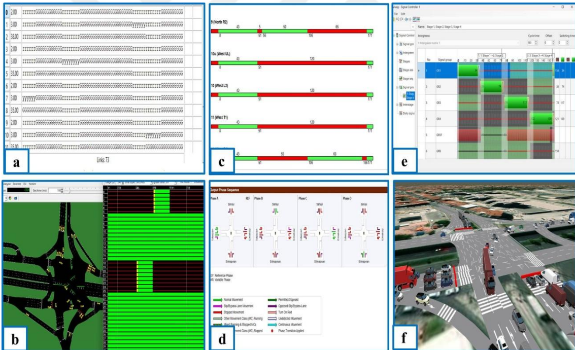
Şekil 4.14. Tezde kullanılan programların zaman diyagramları, a) SUMO sinyal diyagramı, b) SUMO 3D sinyal gösterimi, c) SIDRA Intersection sinyal diyagramı, d) SIDRA Intersection yön bazlı sinyal diyagramı, e) PTV Vissim sinyal diyagramı, f) PTV Vissim'in 3D sinyal gösterimi
