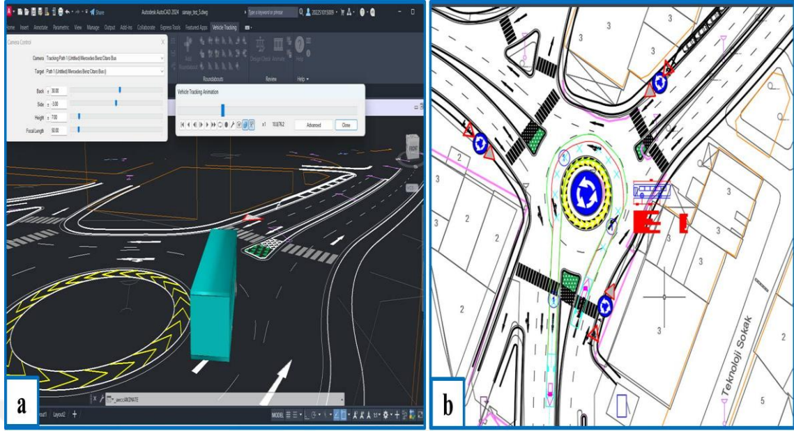
Şekil 4.3. Vehicle Tracking Programı ile kavşak tasarım analizi
