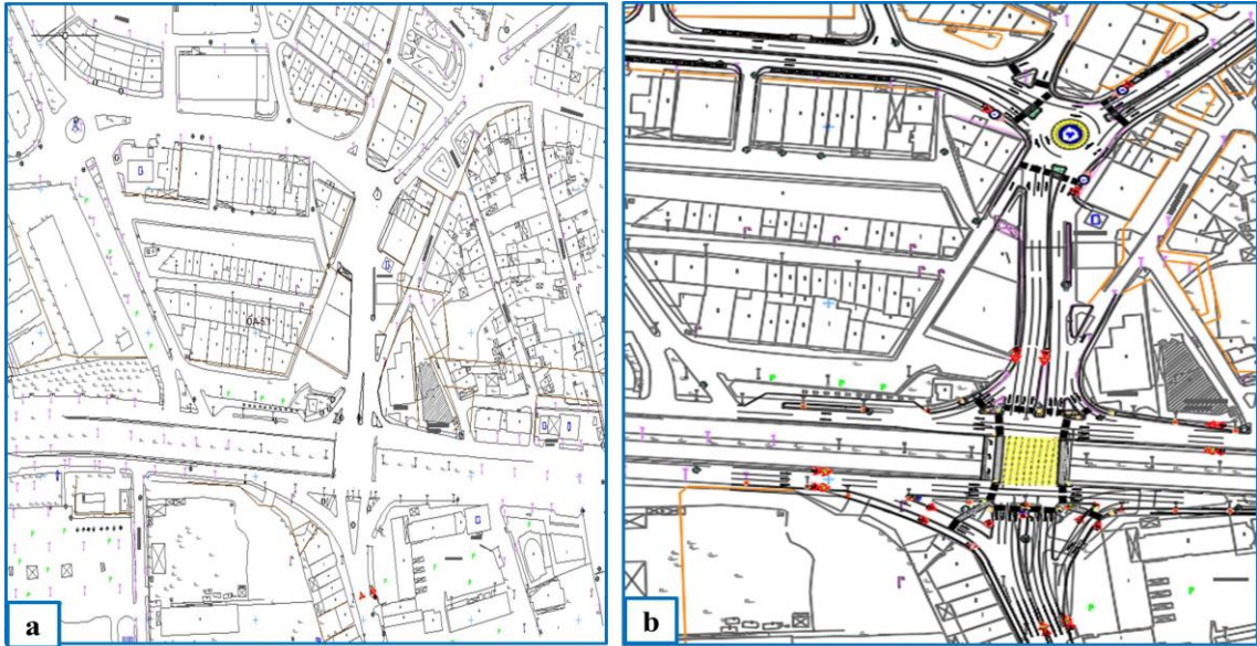
Şekil 4.1. Kömür Tevzi Sokak ile Sanayi Kavşağı, a) halihazır planı (MBBUDB tarafından hazırlanmıştır), b) önerilen geometrik düzenlemeler
