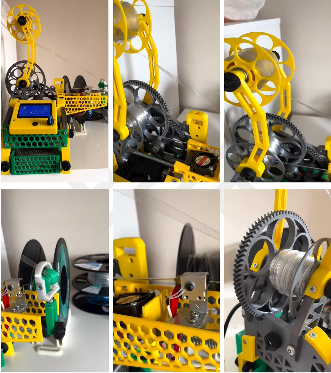
Şekil 34. PET Su Şişesinden Filament Üretim Aşamaları
