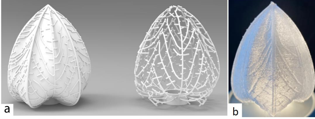
Şekil 31. 3 Boyutlu Yazıcıda Yazdırılan Physalis Alkekengi a) Bilgisayar Ortamında Hazırlanan Model b) Yazdırılan Objeye
