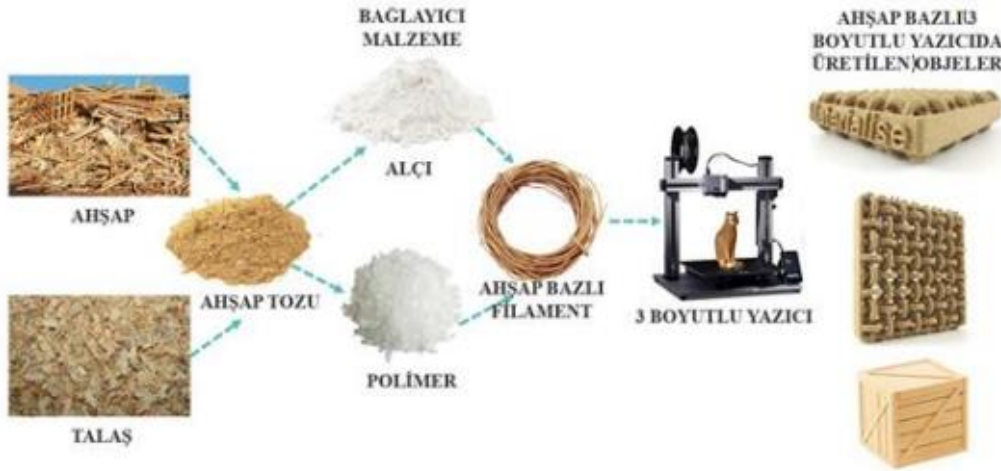
Şekil 20. Ahşap Bazlı Geri Dönüştürülmüş Filament Üretim Aşamaları
