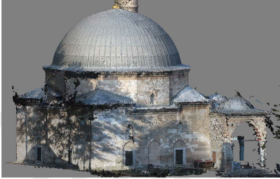
řekil 5.5 İHA verisinden retilmiř nokta bulutu, gneydođu aksonometrik grnts
