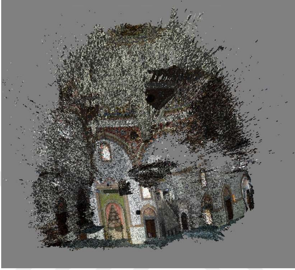
Şekil 5.11 Hafif (Mild) derinlik filtresi ile oluşturulmuş yoğun nokta bulutu
