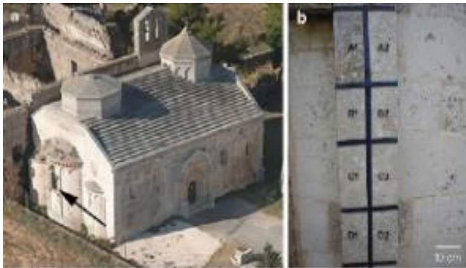
Şekil 157. San Leonardo di Siponto Kilisesi ZnO uygulaması/İtalya. a)Dış cephesi b) Test alanlarının gösterimi (Uyar Z. , 2024).
