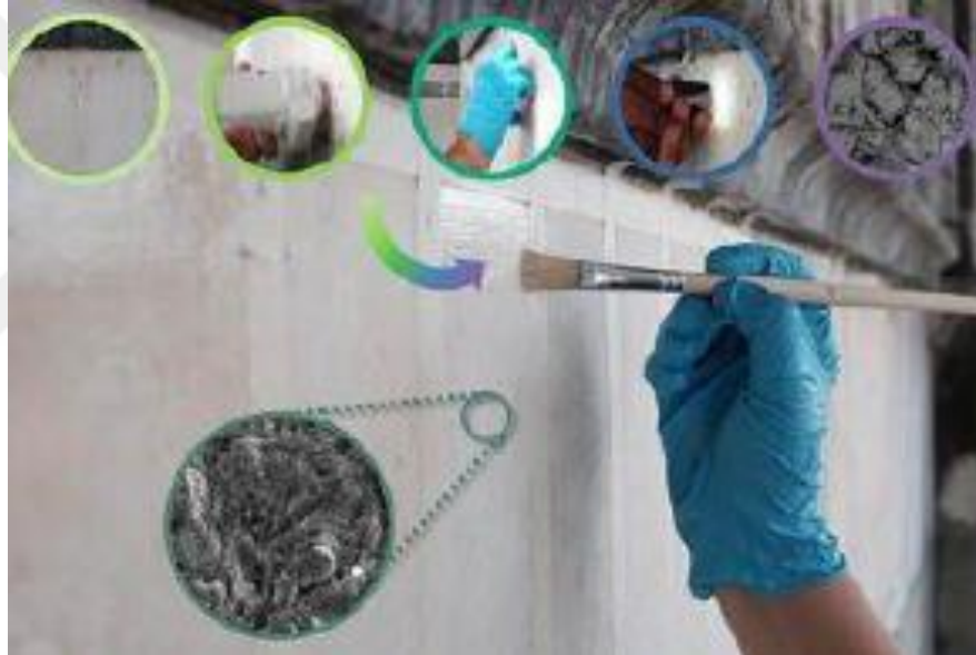
Şekil 159. İşlenmemiş ve işlenmiş taş yüzeylerdeki kendi kendini temizleme işlemlerinin şematik gösterimi (Sierra-Fernandez, Gomez-Villalba, Rabanal, & Fort, 2017; Karkas, 2020).
