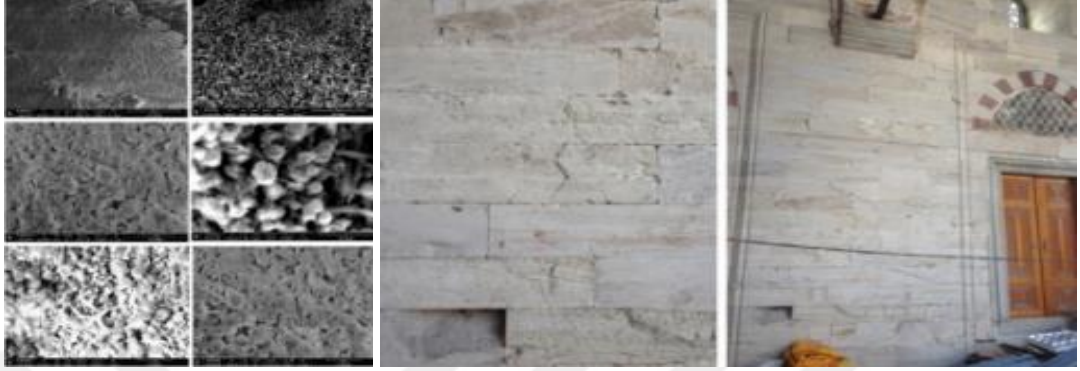
Şekil 168. Beyazıt Camii avlu duvarı numunesinde yapıda nanotedavi öncesinde mevcut olan bütün kırık ve çatlakların nanopartiküllerle doldurulduğu ve karbonatlaşma süreci sonrasında kemikleşerek yapıya mukavemet kazandırdığı nano- tedavi sonrasında açıkça görülmektedir (Dölgen, 2016; Uyar Z. , 2024).
