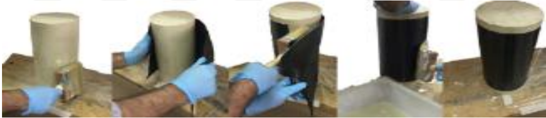
Şekil 89. LAR ile yapılan FRP uygulamasının adımları (Cascardi, Dell'Anna, Micelli, & Lionetto, 2019).
