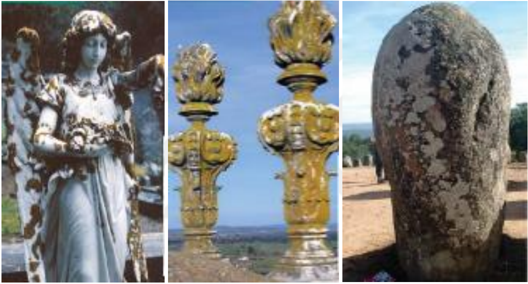
Şekil 137.Farklı taş türlerinde liken oluşumu (ICOMOS-ISCS, 2008).
