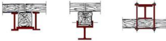
Şekil 75. Ahşap kirişlerin çelik elemanlarla güçlendirilmesine bazı örnekler (Cöcen, 2014).
