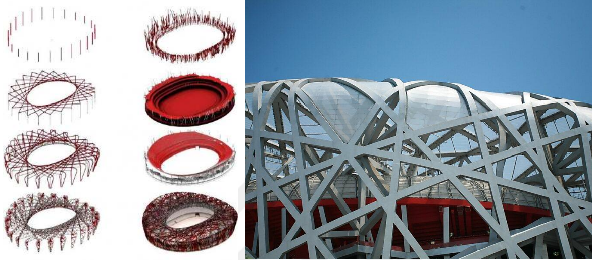
Şekil 4.15. Pekin Ulusal Stadyumu strüktür diyagramı ve cephe detay fotoğrafı (URL-54, 2022; Mehta vd., 2019)
