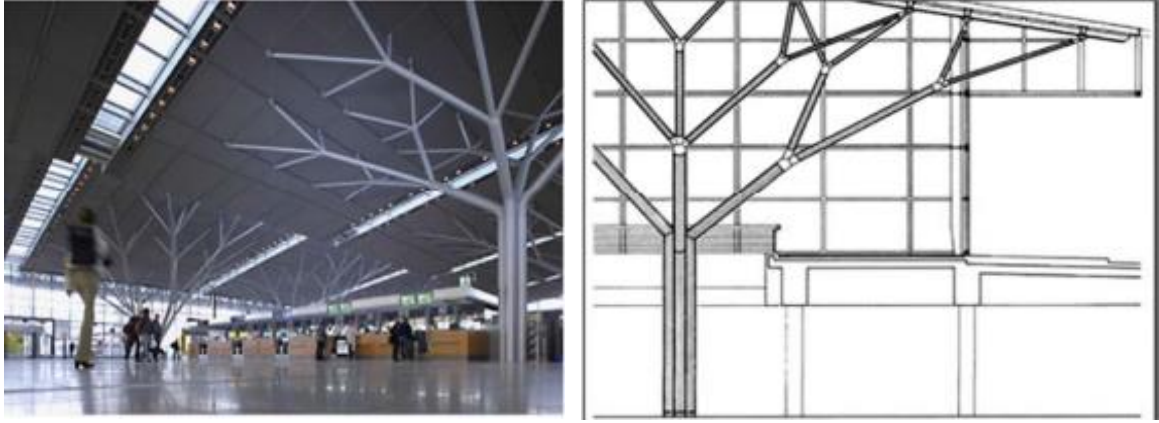
Şekil 4.3. Ağaç şeklinde taşıyıcı kolonlar ve kesit (Lauriola, 2017)
